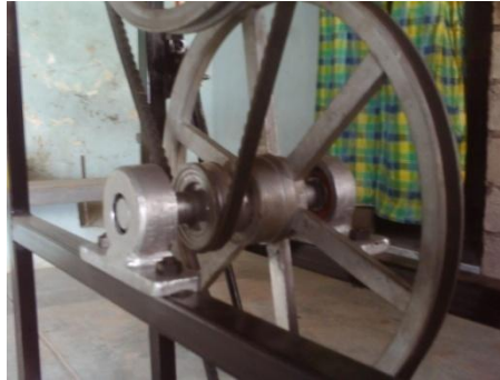
Foto N-º 4.3 Montaje de la chumacera, con sus dos poleas
