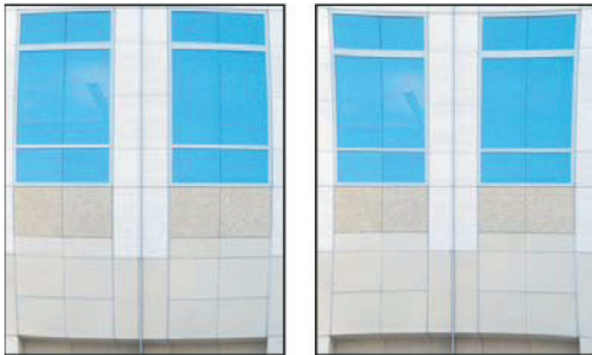
Figura 1.28 Ejemplos de distorsión esferoide (izquierda) y distorsión en corsé (derecha)
