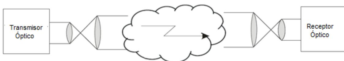
**Figura 2.1 Esquema simplificado de una transmisión FSO**
