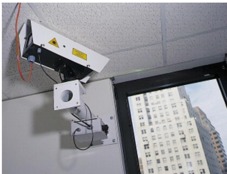
**Figura 2.6 Dispositivo FSO conectando dos oficinas de derecho, Cadwalader, Wickersham & Taft, a 100m en edificios comerciales en Manhattan, link de 1,25 Gb/s**
