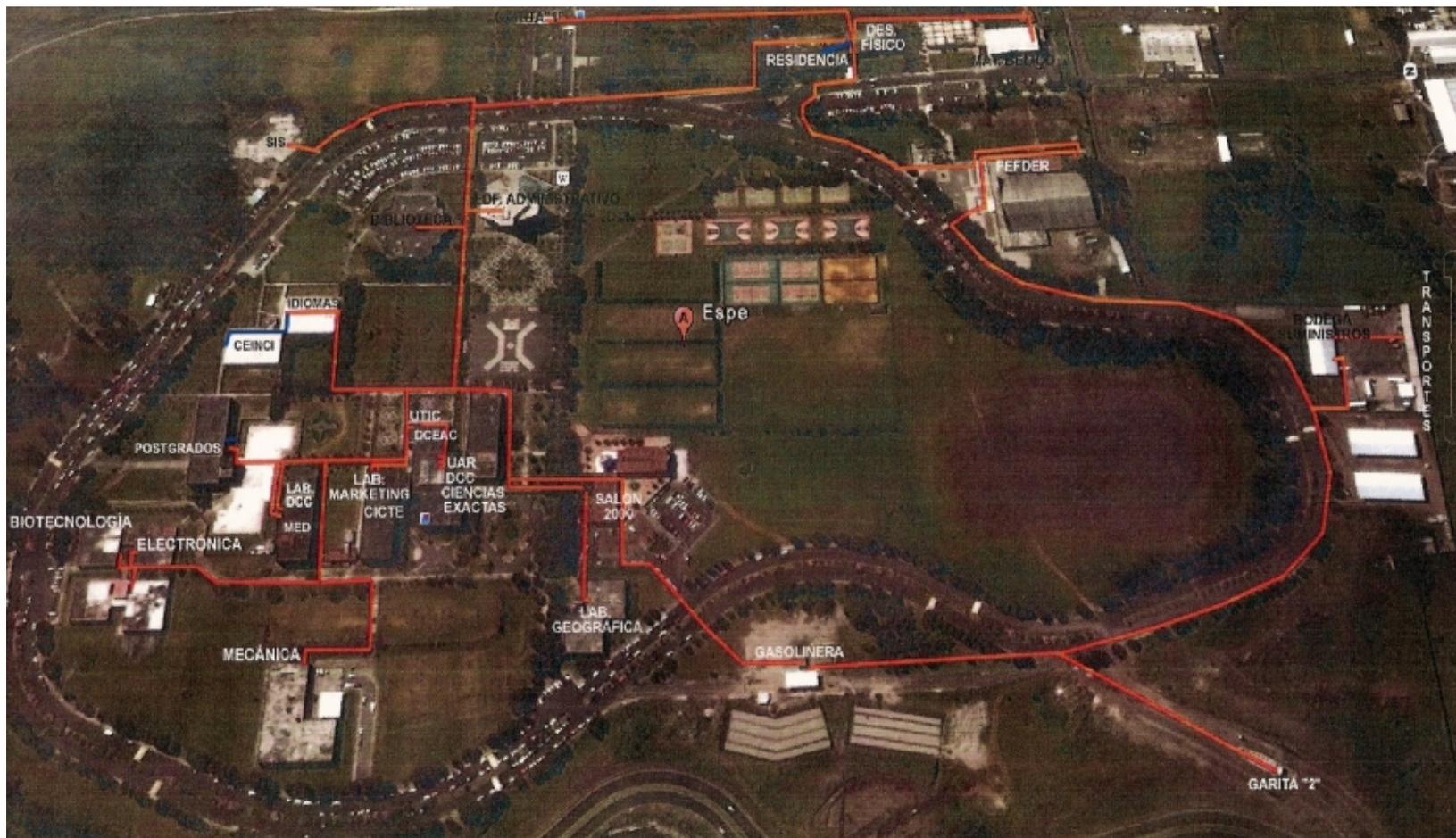
Figura 4.1 Cableado de Fibra Óptica en la Escuela Politécnica del Ejército<sup>18</sup>
