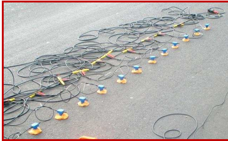
Figura 4.17 Colocación de Geófonos en nuestra línea de estudio
