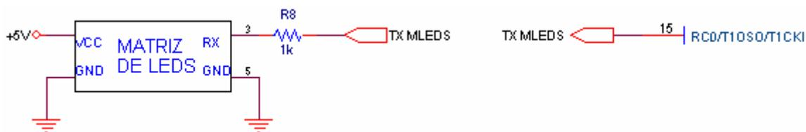
Figura. 4.18. Conexión entre la matriz de leds 7x50 y el PIC16F877A
