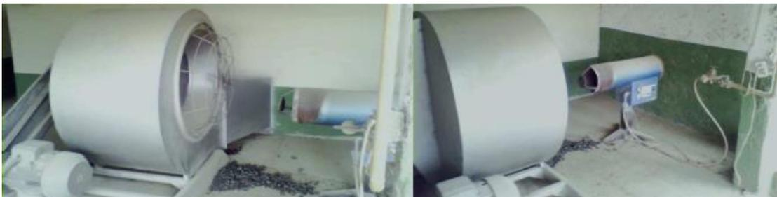
**Figura 5.6.** Quemador y blower<sup>59</sup>
