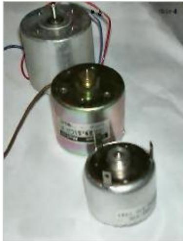
Figura 6.24. Motores de CC<sup>97</sup>
