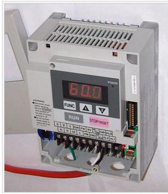
Figura 6.22. Variador de frecuencia<sup>94</sup>
