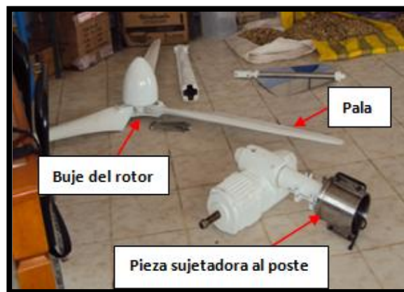
Figura 3.2: Partes previamente ensambladas para su montaje
