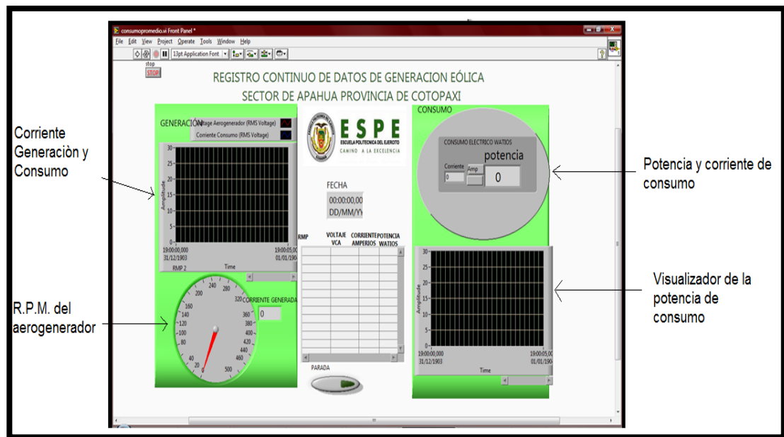
Figura 2.46. Panel de control del sistema de Adquisición
