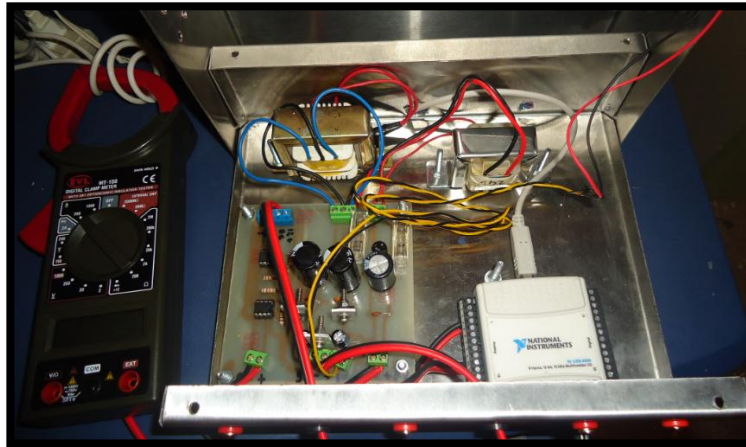
Figura 2.36: Partes que conforman el equipo de adquisición
