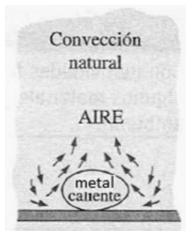
Figura 1.18: Enfriamiento por convección natural.
