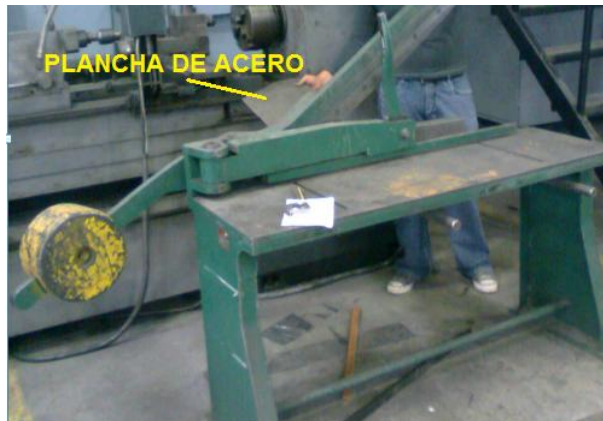
Figura 3.8: Proceso de corte con Cizalla.
