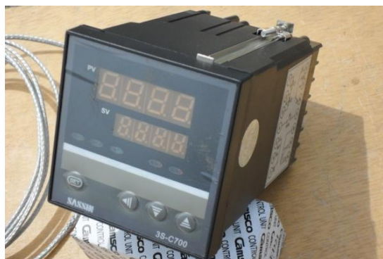
Figura 2.27: Aspecto exterior del Controlador de Temperatura.
