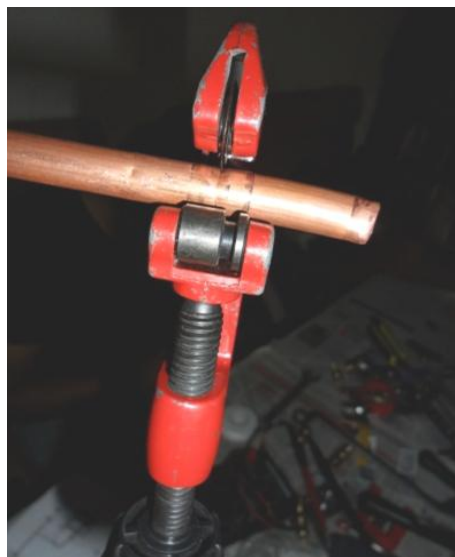
Figura 3.21: Proceso de Corte del tubo de Cobre.
