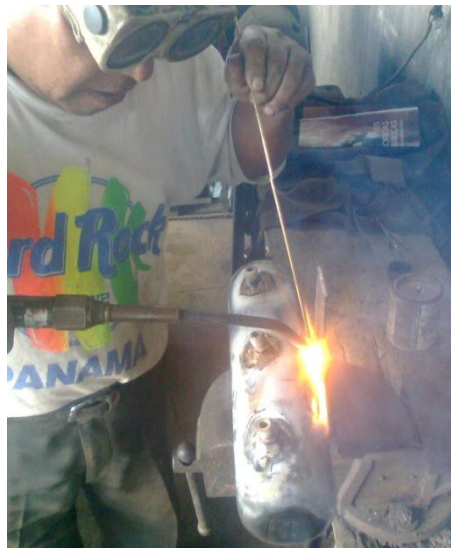
Figura 3.20: Construcción de la Centralina de gas.
