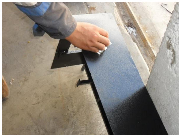
Figura 4.3: Prueba de Rayado de los activos curados.
