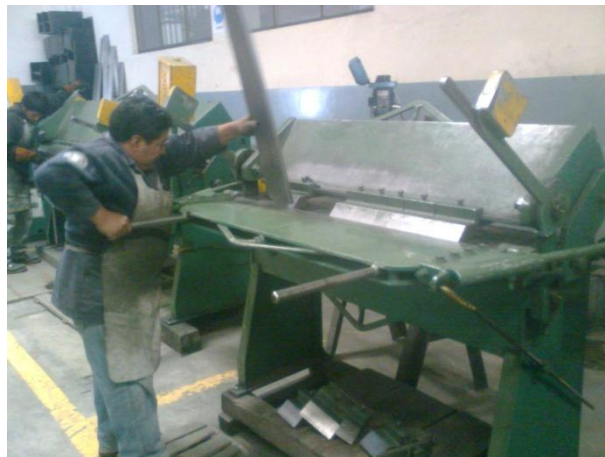
Figura 3.10: Proceso de Doblado.
