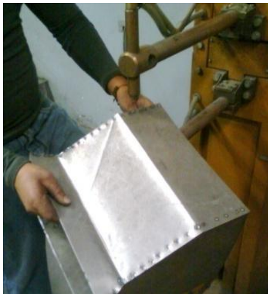
Figura 3.13: Proceso de unión con Suelda de punto.
