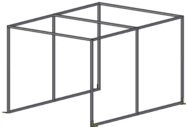
Figura 2.3: Estructura del Horno estimada con 6 pórticos.
