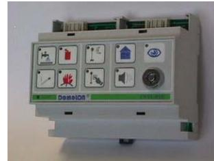
Incorpora dos relés de conmutación, activados y desactivados por variable de red. Se coloca en el carril DIN de la caja de empotrar ICE-36G.
