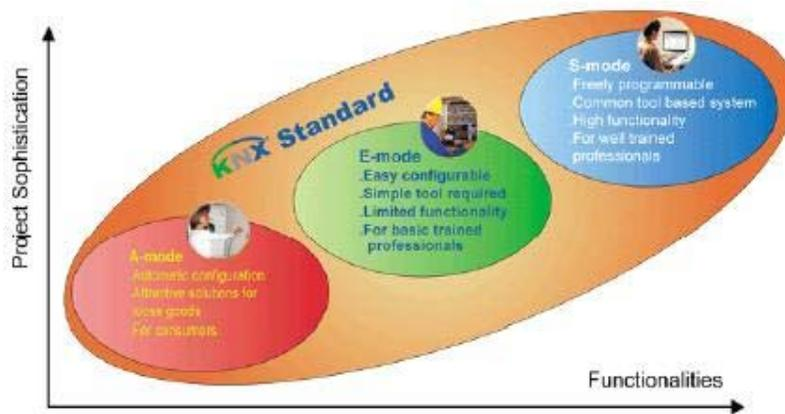
**Fig. 1.3.e Modos de funcionamiento del estándar Konnex KNX. Los modos A y E están específicamente indicados para su instalación en hogares.**
