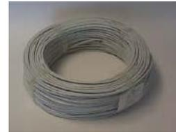
El cable de sensores CCP-22 se emplea para el cableado de sensores de presencia, fuego, gas y humo. Está compuesto por dos pares de hilos de 0.22mm (rojo - verde y amarillo - blanco). Se emplean el rojo y verde para alimentación y el amarillo blanco para el contacto. El cable recomendado para las sondas de agua es un cable paralelo de 0.5 ó 0.75mm de sección ya que es un cable flexible, manejable y fiable.
