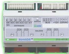
La versión INS-451-XT dispone de una entrada para sonda de temperatura digital IST-010. El nodo suministra alimentación local a los sensores a él conectados.
