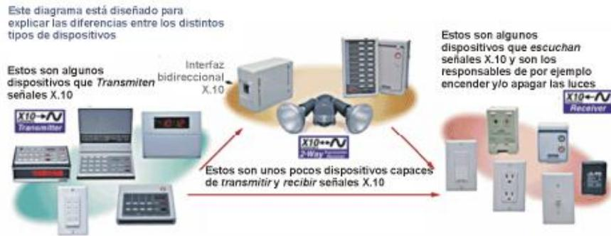
**Fig.1.3.b Diagrama explicativo de los diferentes modos de funcionamiento de los dispositivos X-10**
