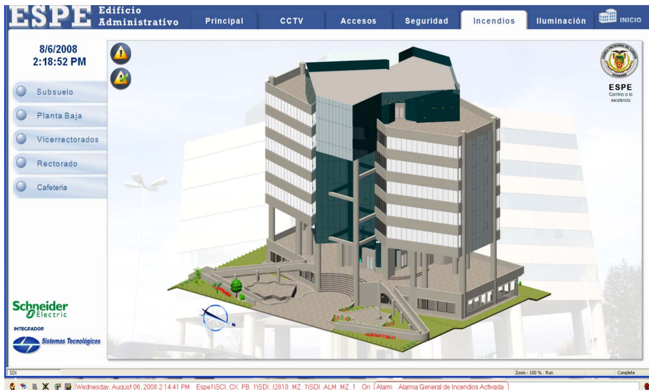
Figura 6.30.- Ventana Principal de los sistemas Integrados en el Edificio Administrativo ESPE.
