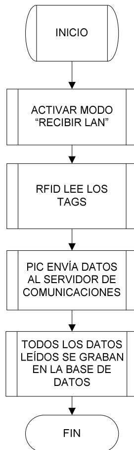
Figura 4. 30 Flujograma, funcionamiento del servidor de comunicación en MODO RECIBIR LAN
