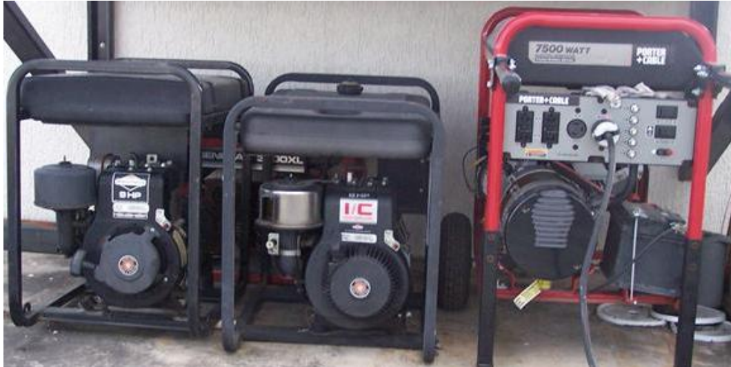
Figura 3.3 Generador PORTER CABLE 7500WATT Y 2 MOTORES
