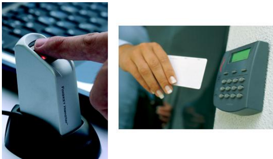
Figura 2.15 Control de acceso dactilar y con banda magnética
