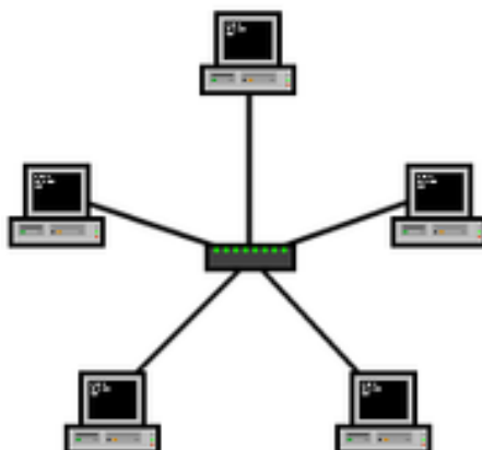
Figura 2.1 Un conmutador en el centro de una red en estrella.
