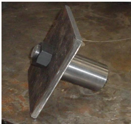
**Figura 5.96 Placa superior de columna**
