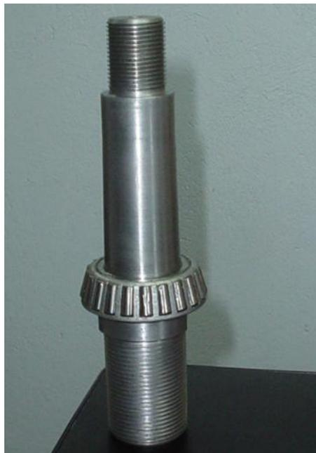
**Figura 5.98 Eje y rodamiento cónico**
