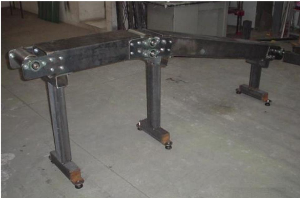
**Figura 5.95 Montaje de transportador**
