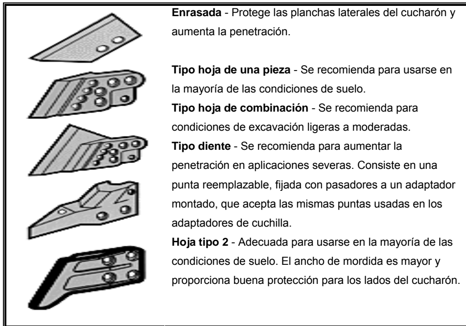
FIG 2-98 Tipos de Orejetas
