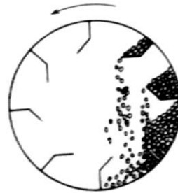
Figura 4.4: Lecho de sólidos móviles dentro de un secador rotatorio
