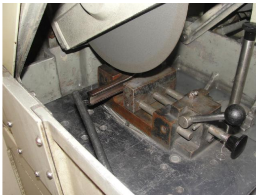
Figura 2.1 Corte Transversal de la Probeta
