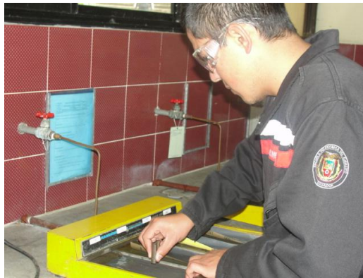
Figura 2.2 Proceso de lijado con lijas de diferente numeración (150-1500)
