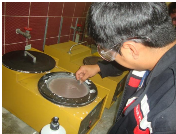
Figura 2.3 Pulido con alúmina y agua destilada
