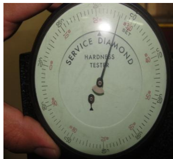
Figura 2.19 Aguja pequeña alineada al triángulo
