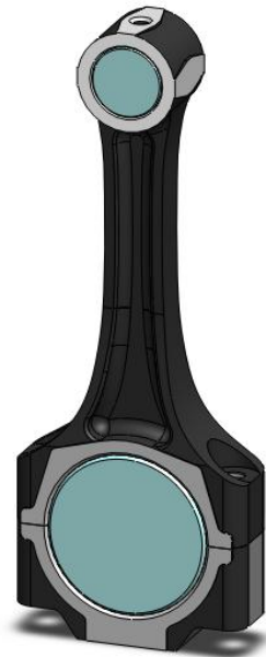
Figura 3.12 Ensamblaje total de la biela Volkswagen Gol
