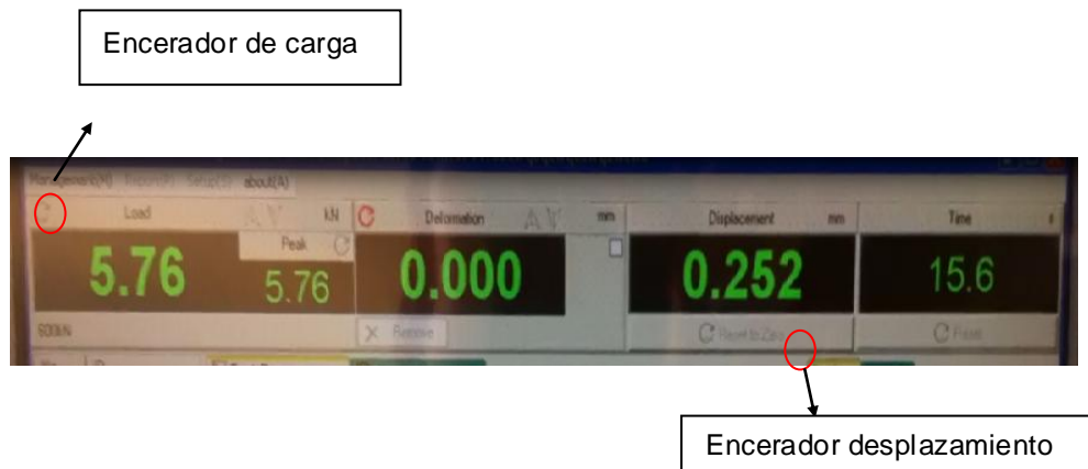
Figura 4.7 Encerado de la máquina
