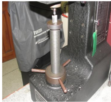
Figura 2.18 Probeta en contacto con penetrador
