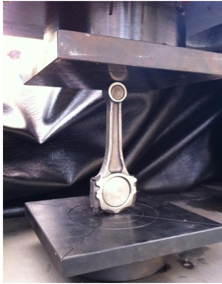
Figura 4.6 Ubicación de la biela entre las placas para el ensayo a compresión
