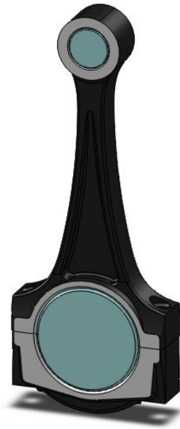
Figura 3.17 Ensamblaje total de la biela Chevrolet Corsa
