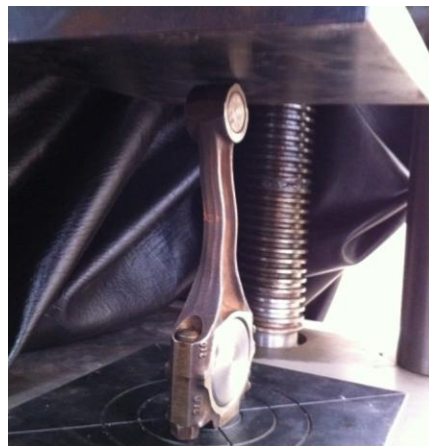
Figura 4.11 Biela Volkswagen Gol deformada
