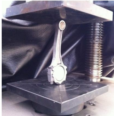
Figura 4.9 Biela Kía Río deformada
