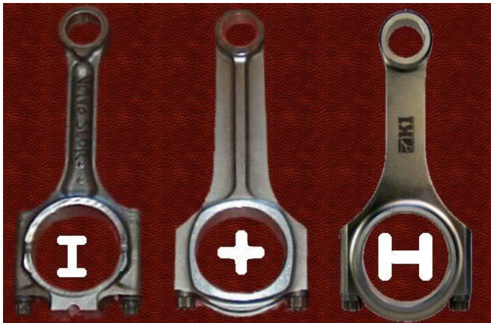
Figura 1.5 Perfiles I,+ y H respectivamente.
