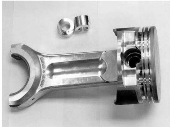
Figura 1.2 Esquema de una biela forjada
