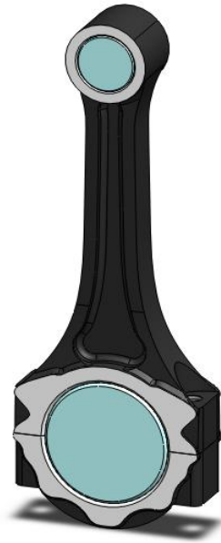
Figura 3.7 Ensamblaje total de la biela Kía Río
