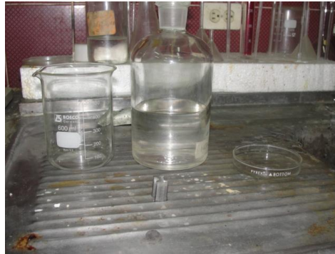
Figura 2.4 Ataque químico con Nital al 3%
