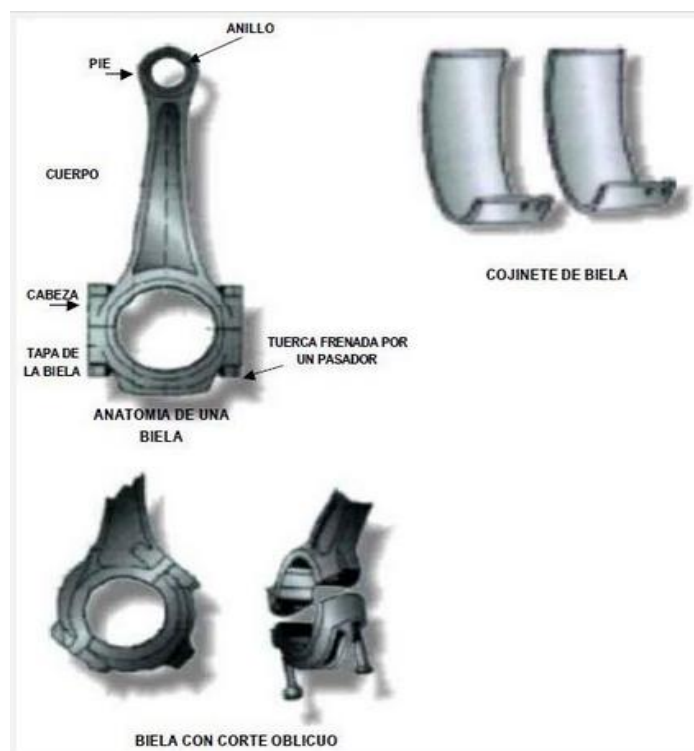
Figura 1.4 Partes de la Biela
