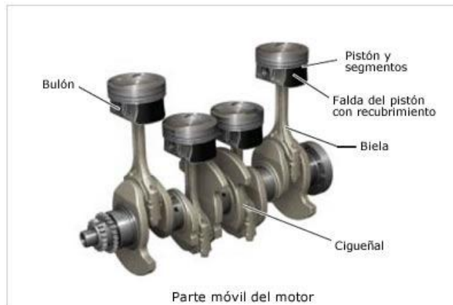
Figura 1.3 Funcionamiento de la biela en el tren alternativo
