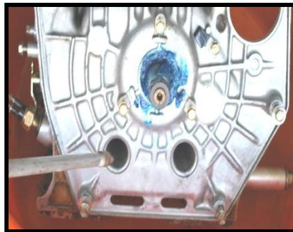
Figura 4.18 Conductos de refrigeración por aire
