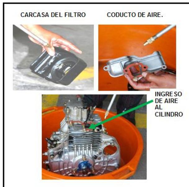
Figura 4.10 Conductos de ingreso de aire
