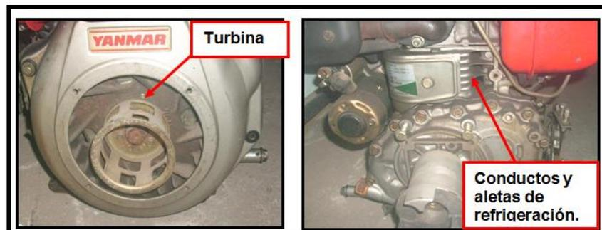
Figura. 3.13 Aletas, conductos de refrigeración por aire y turbina
