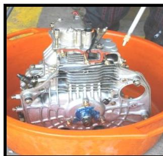
Figura 4.19 Aletas disipadoras de calor
