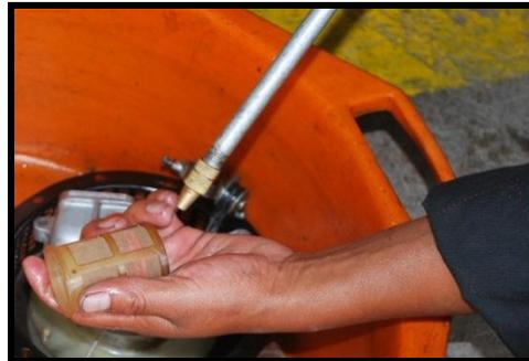
Figura 4.3 Limpieza del filtro de combustible plástico.
