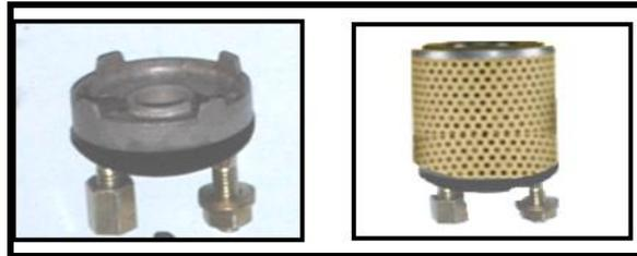
Figura 4.4 Filtro de combustible en malas condiciones y su remplazo
