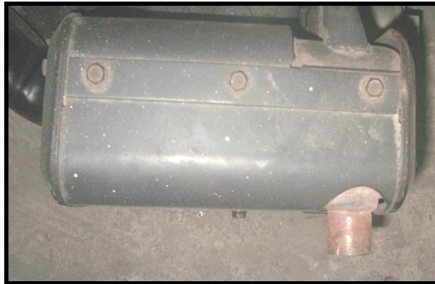
Figura 3.10. Conducto de escape y silenciador.
