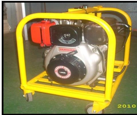
Fig. 4.24 Motor Yanmar totalmente rehabilitado.
