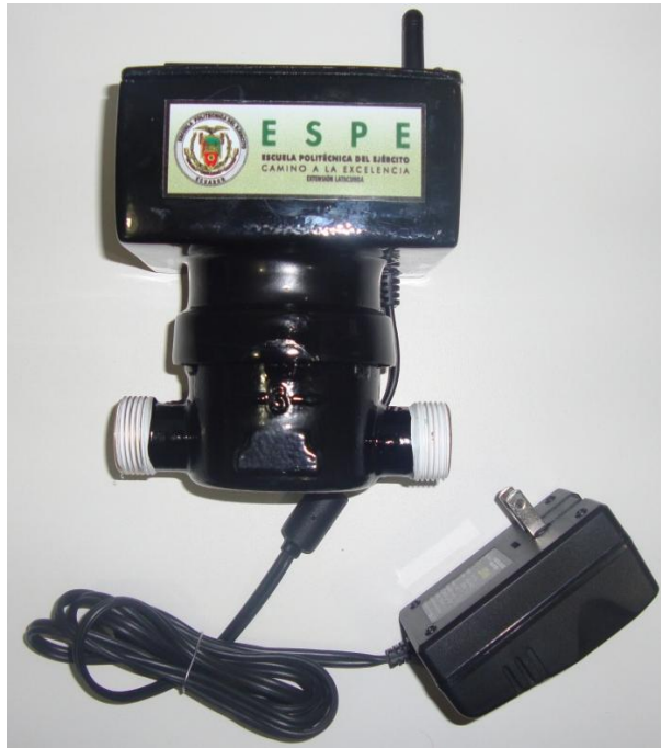
Figura 2.42: implementación final del Medidor Digital
