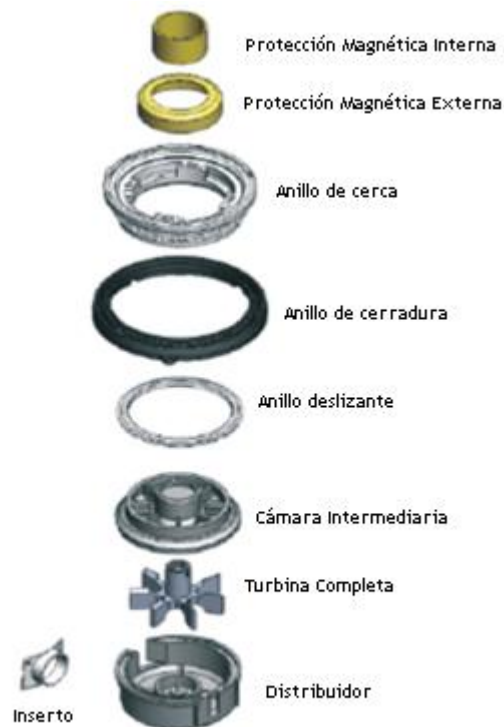
Figura 2.11: Composición del sensor de Turbina
