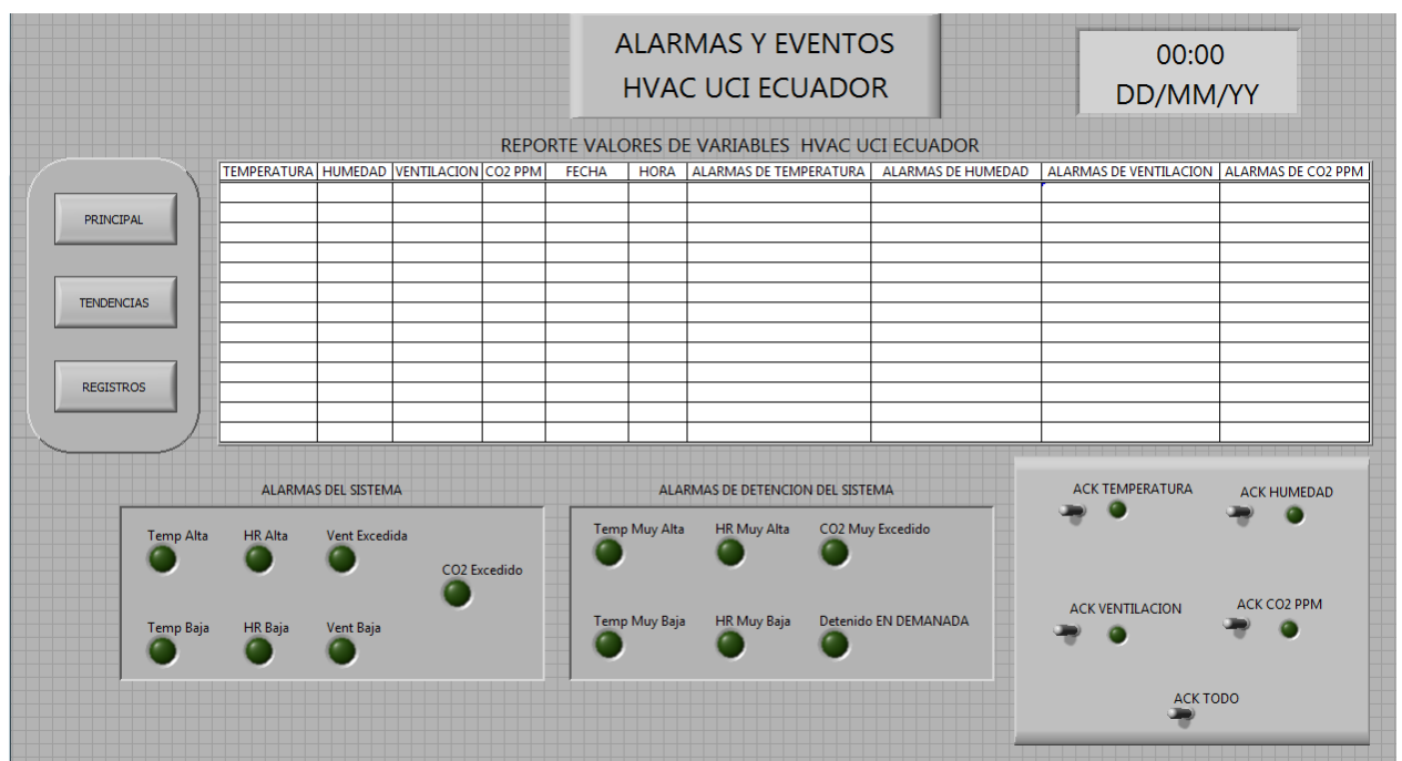
Ilustración 49. Pantalla de alarmas del sistema de control
