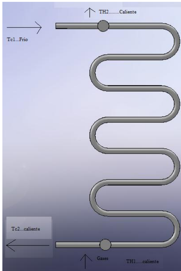
Figura 4.7. Esquema de circulación de Fluido por el Intercambiador de Calor.
