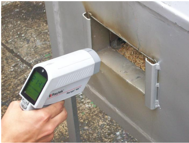
Figura 5. Medición de temperaturas utilizando sensor láser.
