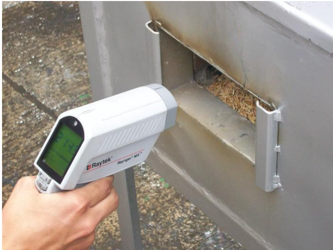
Figura 5. Medición de temperaturas utilizando sensor láser.
