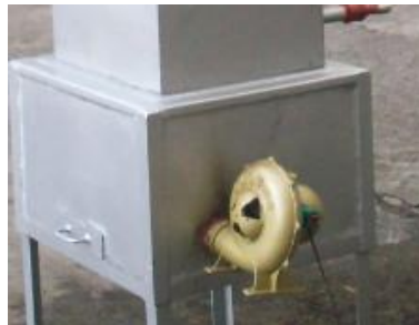
Figura 3 Venterol acoplado a la cámara de combustión.
