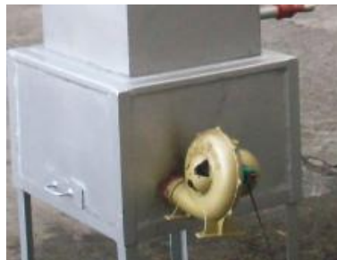
Figura 3 Venterol acoplado a la cámara de combustión.
