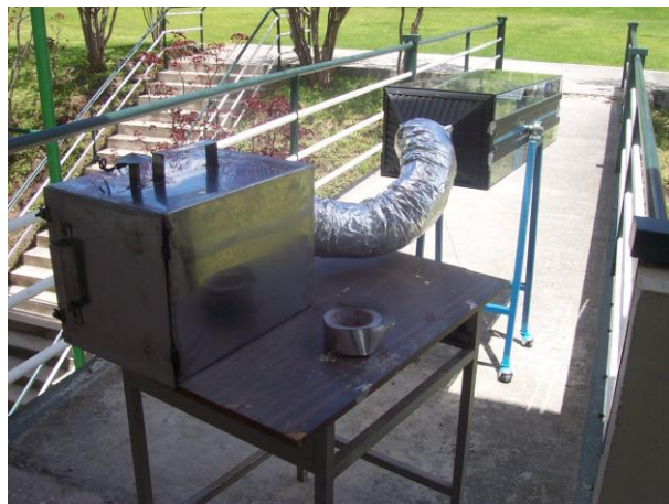
Figura 4.18. Implementación del conjunto a la boca de salida de aire (panel solar)
