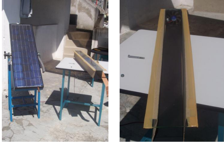
Figura 5.3 Túnel de Viento enfriado por ventilador accionado por Panel Fotovoltaico
