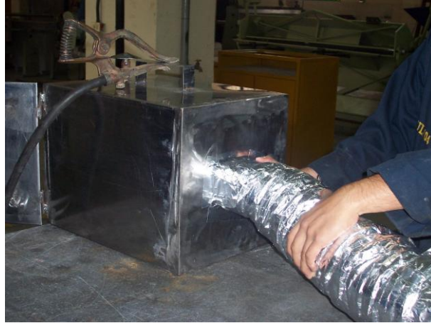
Figura 4.17. Implementación del ducto de aluminio en la boca de ingreso de aire
