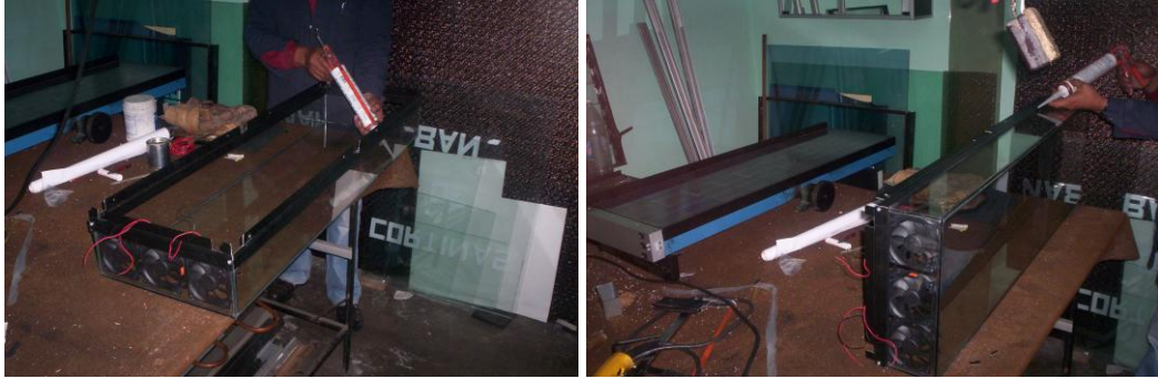
Figura 4.5. Refuerzo total de uniones y juntas en las corzas superior e inferior
