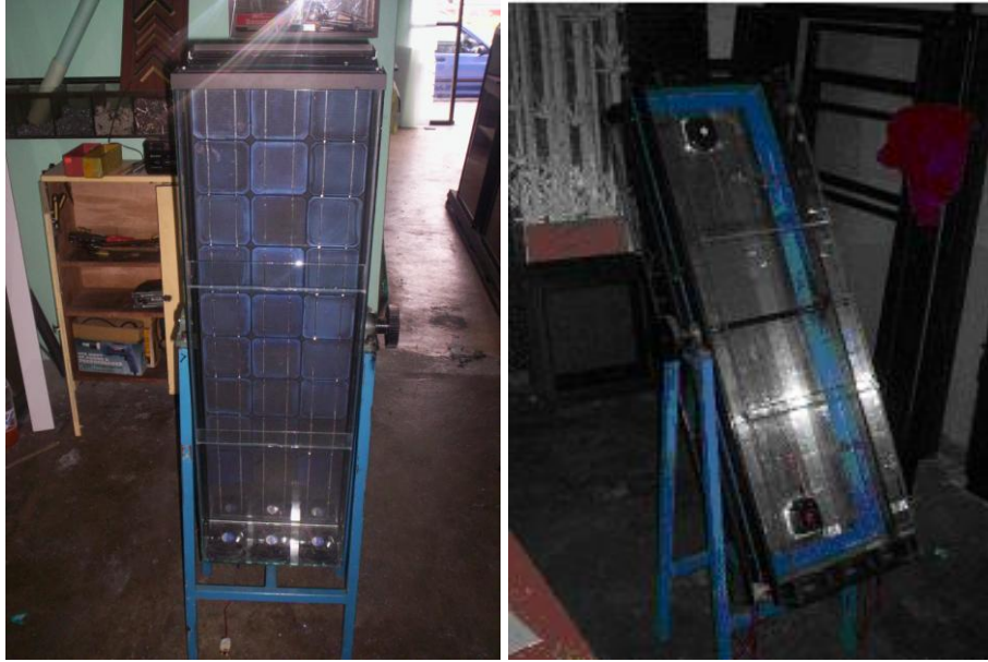
Figura 4.15. Implementación y verificación de fugas de aire finales
