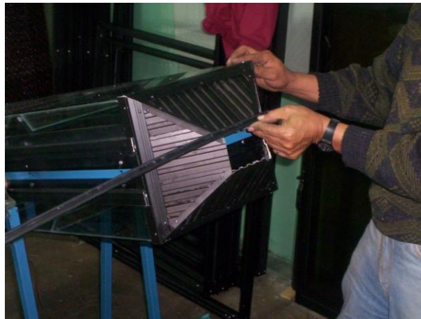
Figura 4.8. Elaboración del ducto de salida de aire
