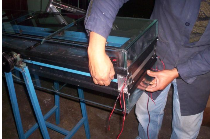
Figura 4.13. Implementación de corazas y conexiones eléctricas
