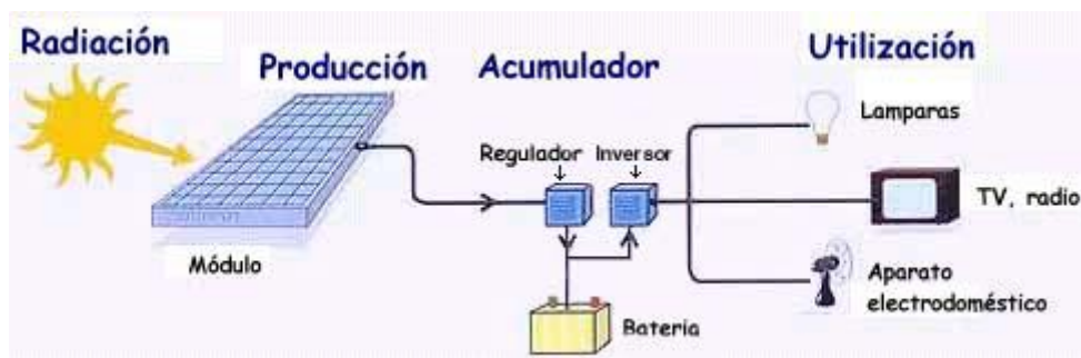
Figura 2.16 Esquema de una Instalación Fotovoltaica
