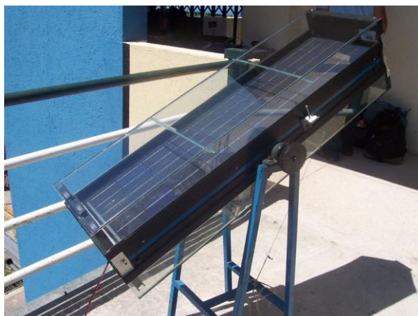
Figura 5.2 Panel Fotovoltaico con Sistema de Extracción de Calor
