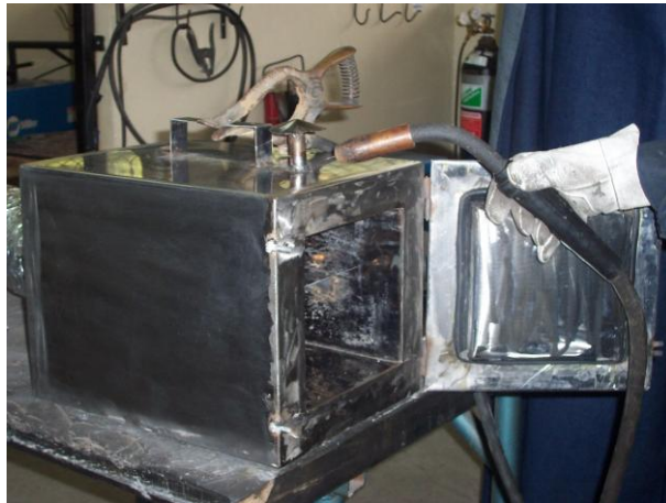
Figura 4.11. Soldadura y armado de la cámara de secado
