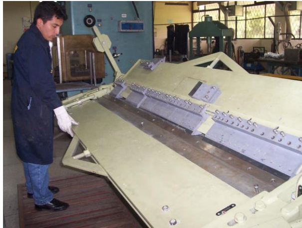
Figura 4.10. Doblado de elementos constitutivos de la cámara de secado
