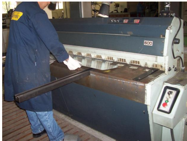
Figura 4.9. Corte de chapa de acero inoxidable según medidas
