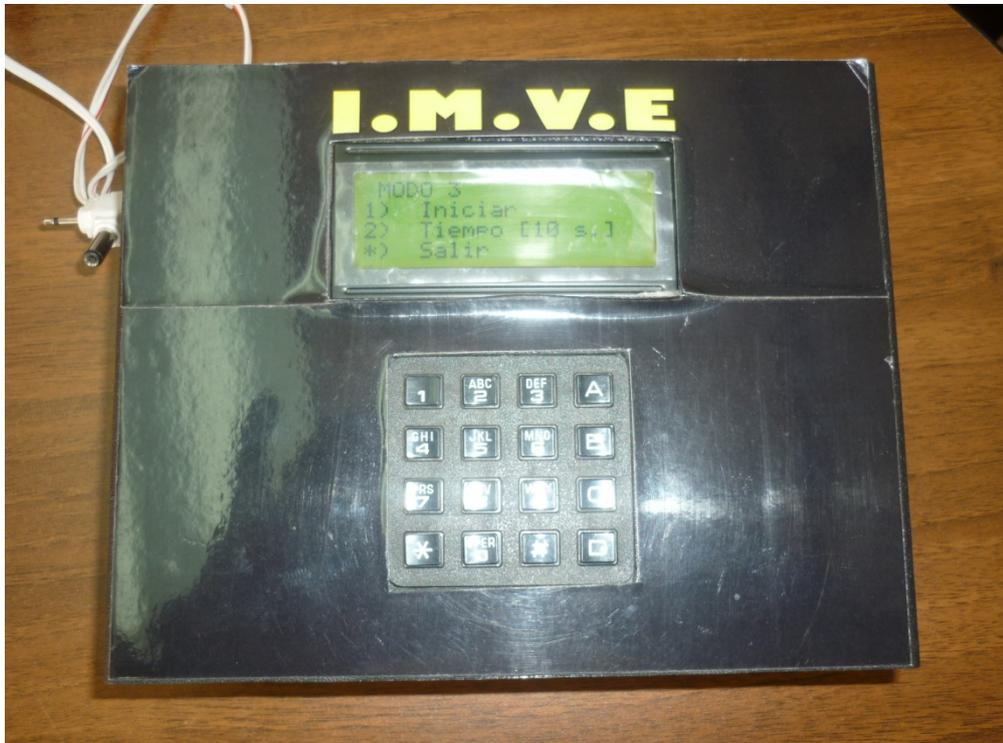
Figura #7. Equipo de medición de los tiempos IMVE.
