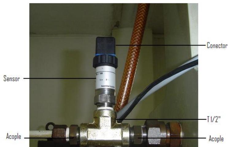
Figura 5-4 Esquema del montaje del transductor de presión.
