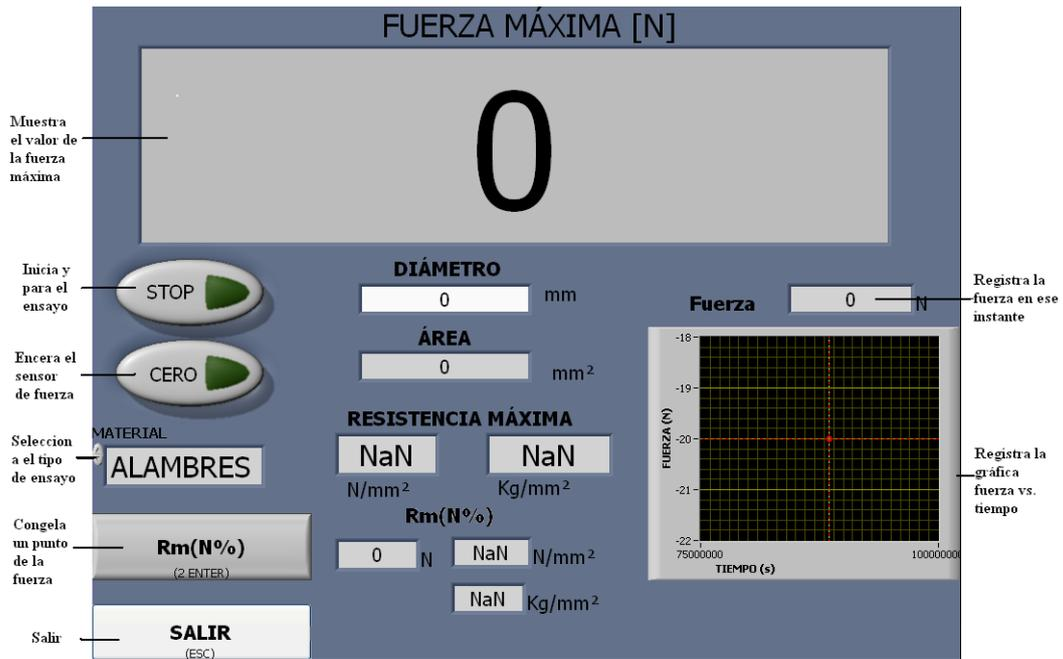
Figura 4-24 Pantalla de ensayos de alambres sin desplazamiento
