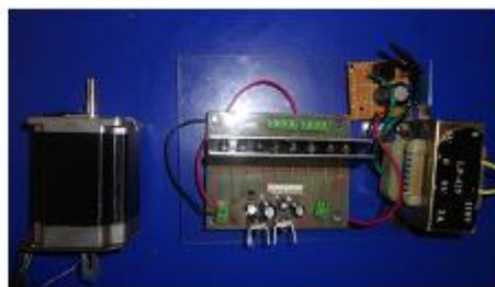
b) Tarjeta Controladora - Fuente de Alimentación con Transformador - Motor Paso a Paso Giro en Azimut
