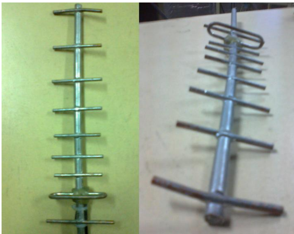
Figura II.14: Antena Yagi – 2.4 [GHz] - Construcción Artesanal.
