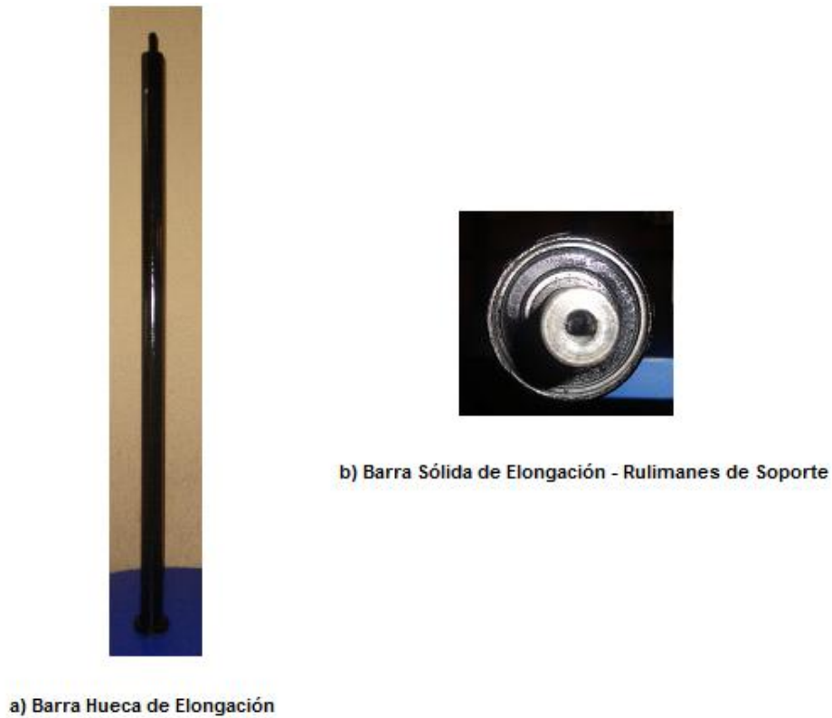
Figura III.20: Estructura de Elongación.
