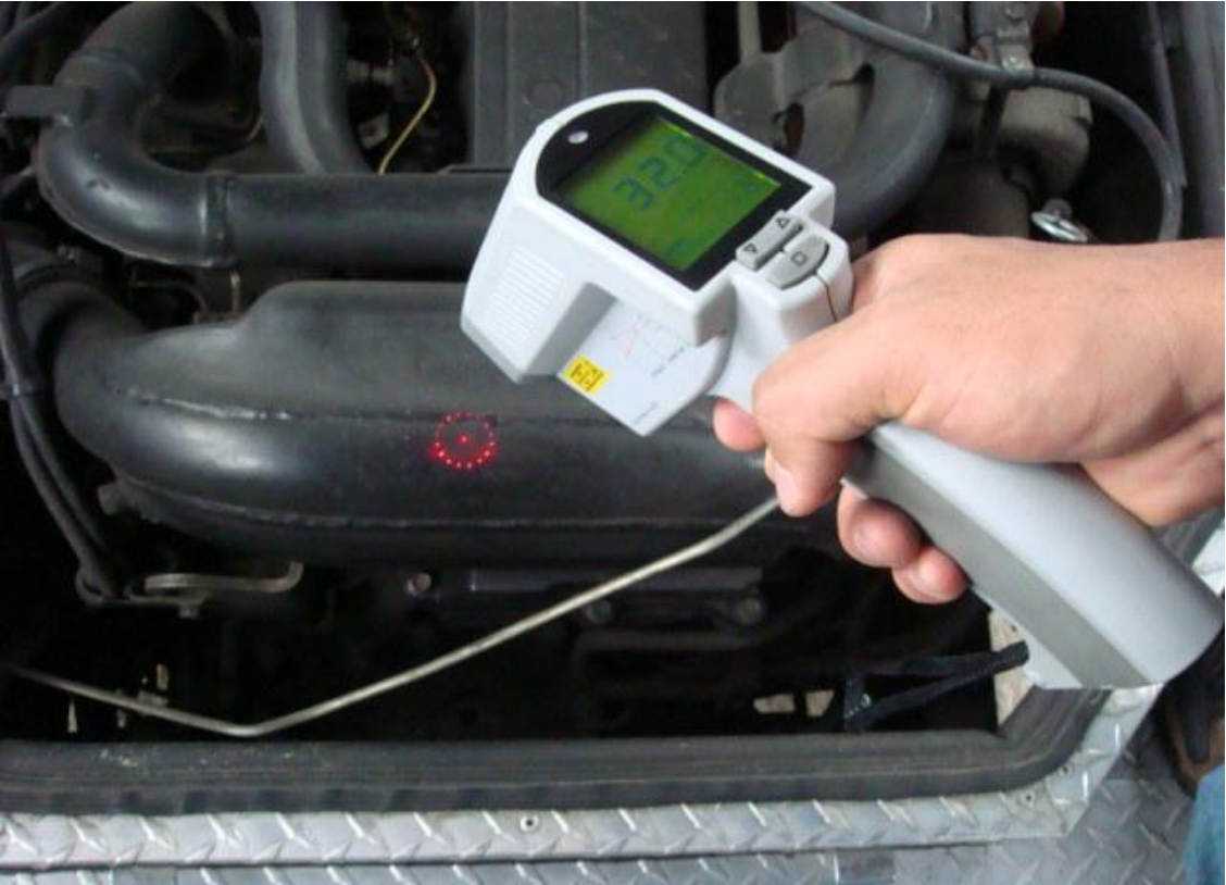
Fotografía 4.11 Toma de temperatura admisión
