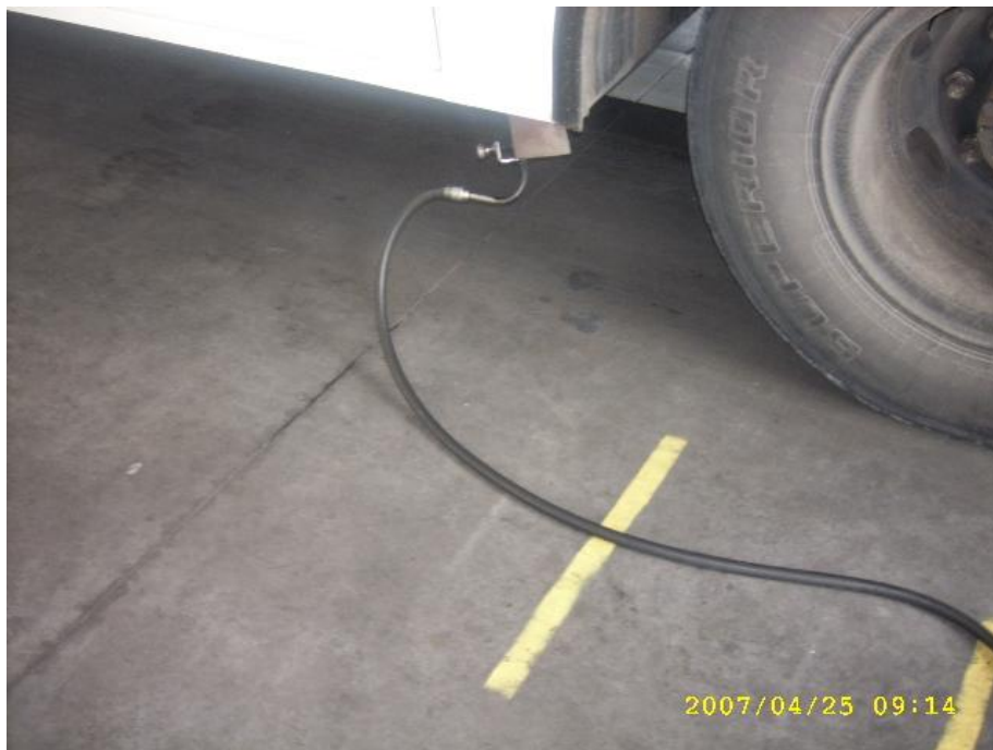
Fotografía 4 Colocación del sensor opacimetro en el tubo de escape
