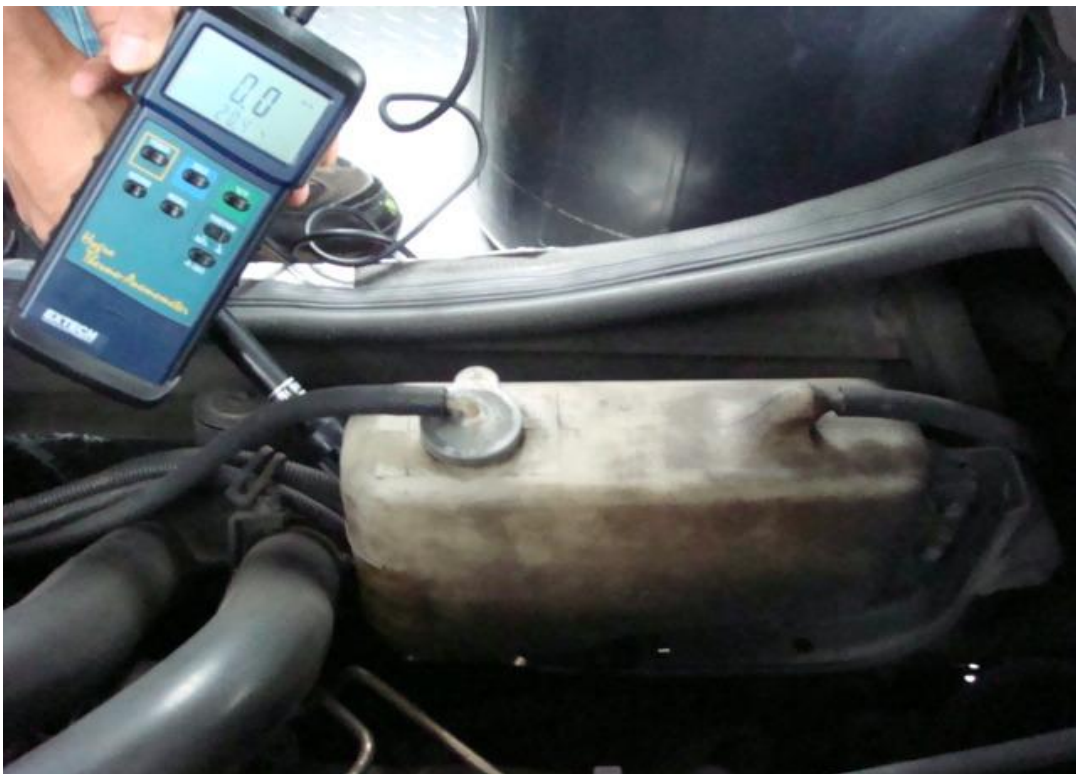
Fotografía 4.15 Toma de temperatura reservorio Ventilador del radiador
