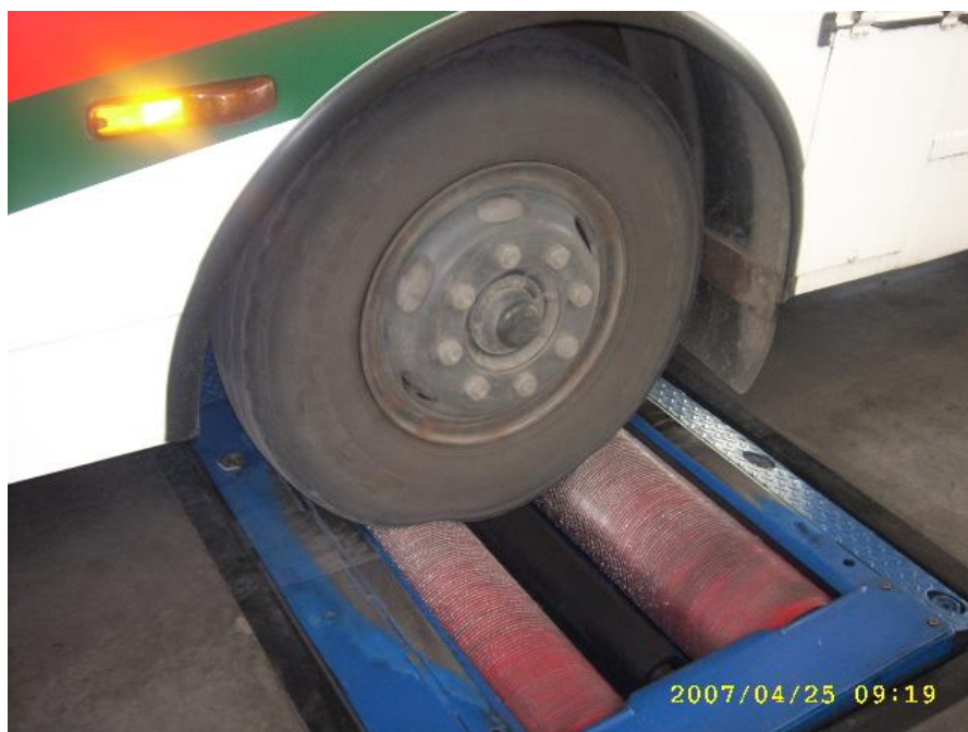
Fotografía 10 Medición de la eficacia del frenado
