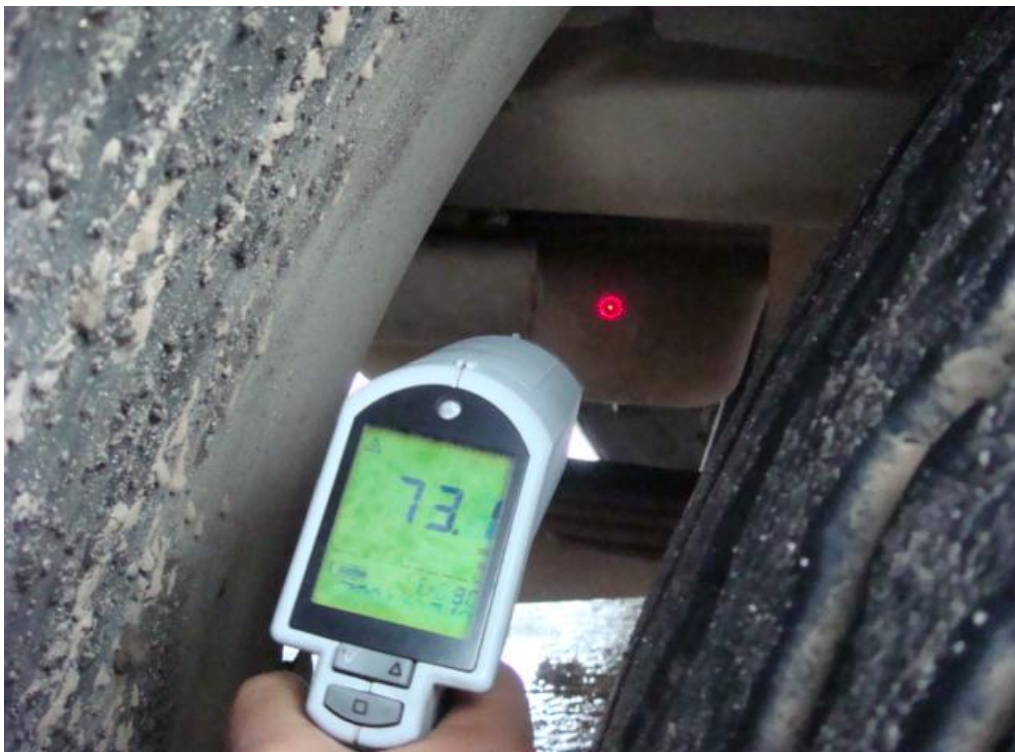
Fotografía 4.9 Toma de temperatura carter
