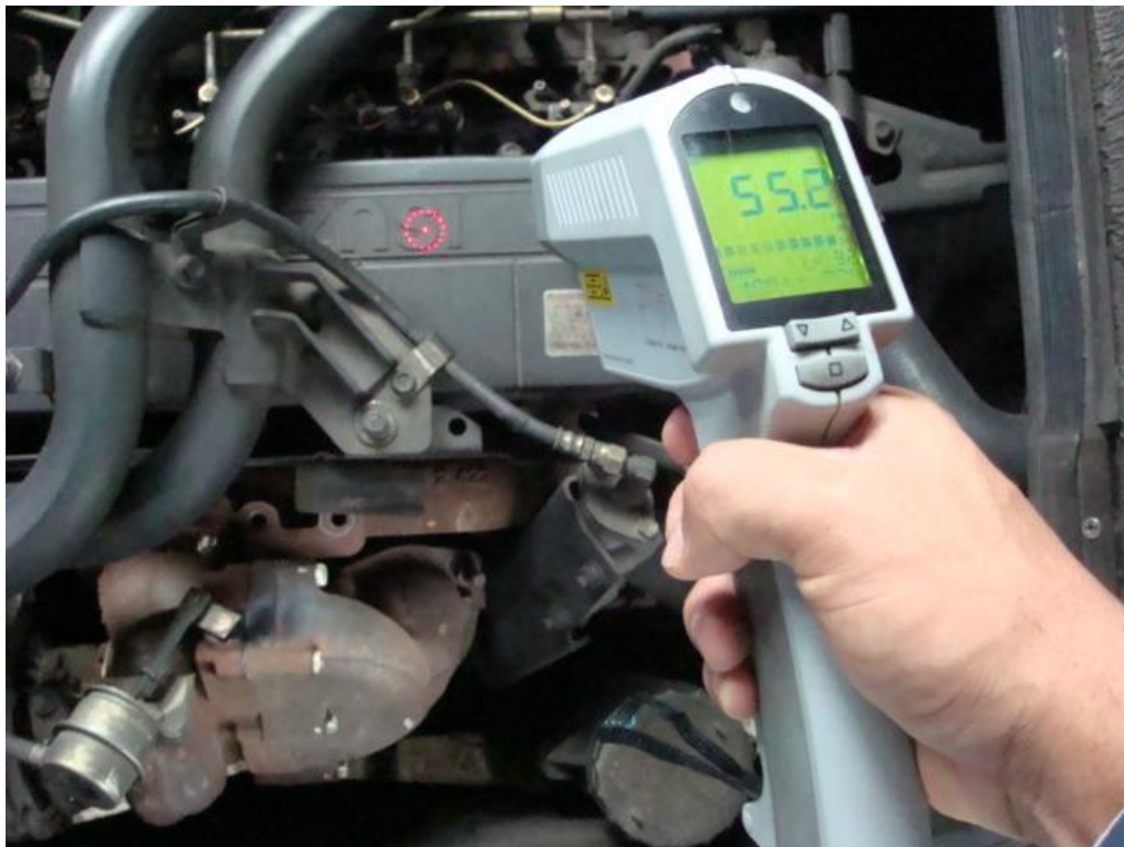
Fotografía 4.10 Medición de temperatura block
