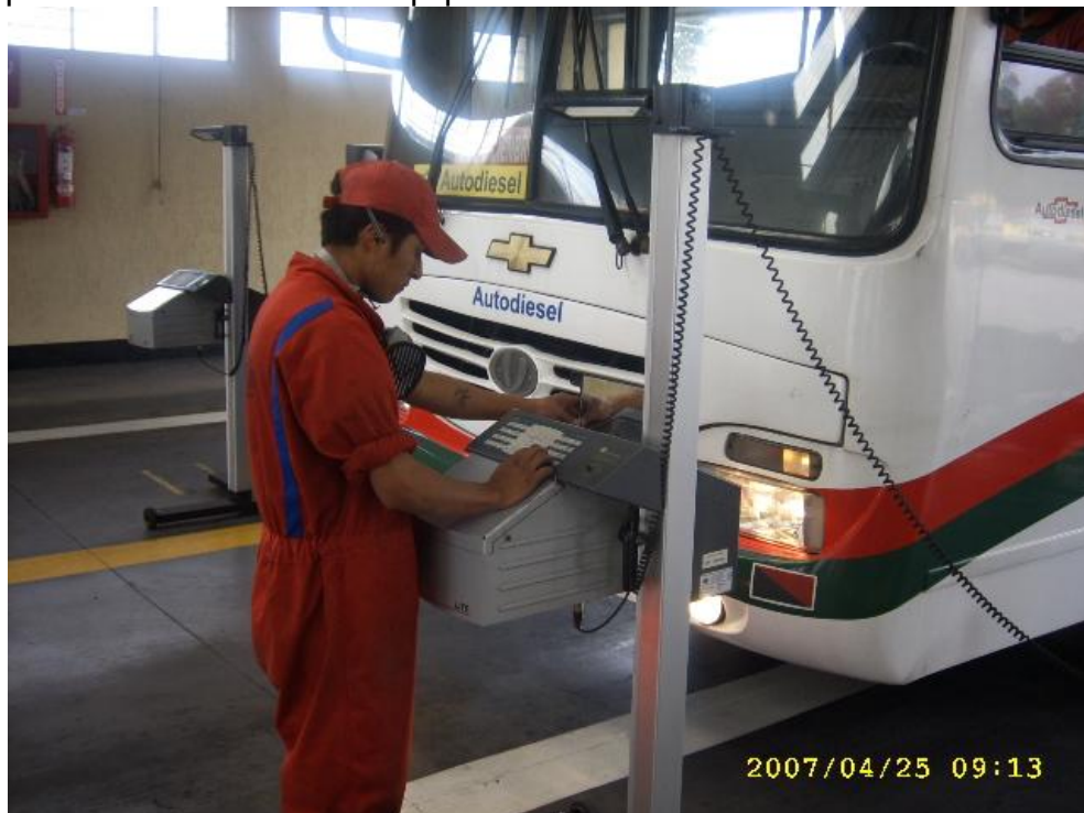
Fotografía 8 Medición de alineación e intensidad de luces altas y bajas
