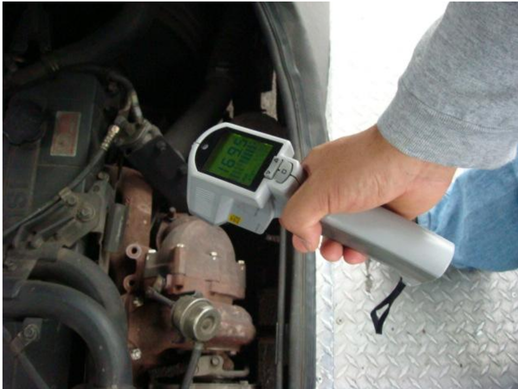
Fotografía 4.13 Toma de temperatura múltiple
