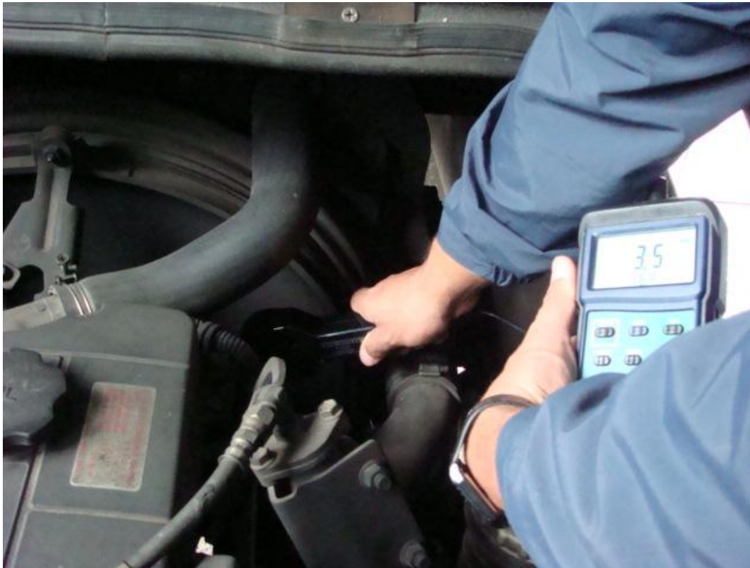
Fotografía 4.16 Toma de lectura velocidad del radiador
