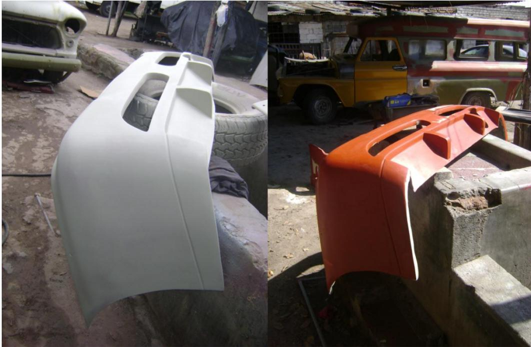
**Figura No. 109: Fondeado y masillado primario de Faldón Trasero.**
