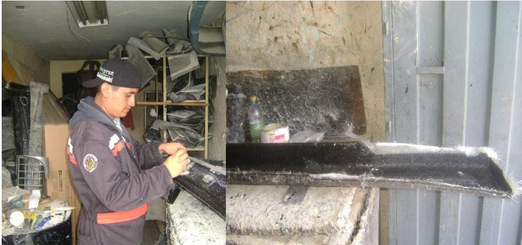
**Figura No. 100: Colocación de fibra de vidrio con mezcla de resina sobre la matriz tratada y seca por cuatro horas para la fabricación de los estribos laterales.**
