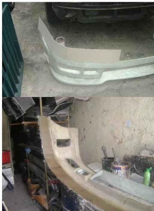
**Figura No. 96: Tratamiento de Matriz de Fibra de Vidrio para la construcción del Faldón Delantero.**
