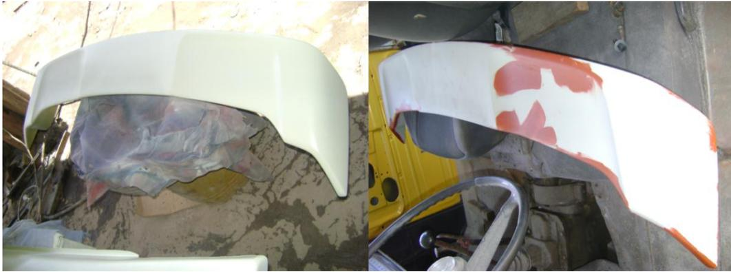
**Figura No. 106: Fondeado y masillado primario del Alerón.**
