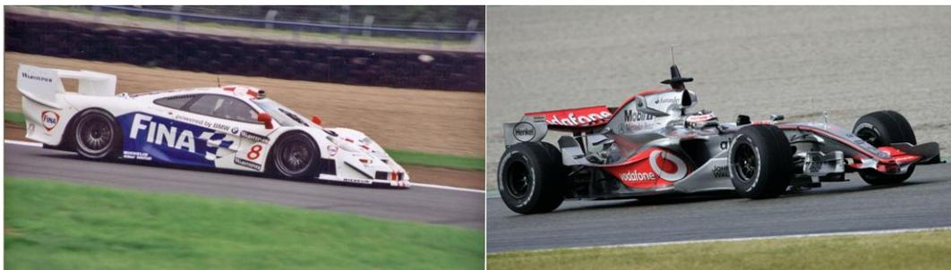
**Figura No. 5: El McLaren F1GTR tiene una forma menos “resistente” que el McLaren de Fórmula 1.**
