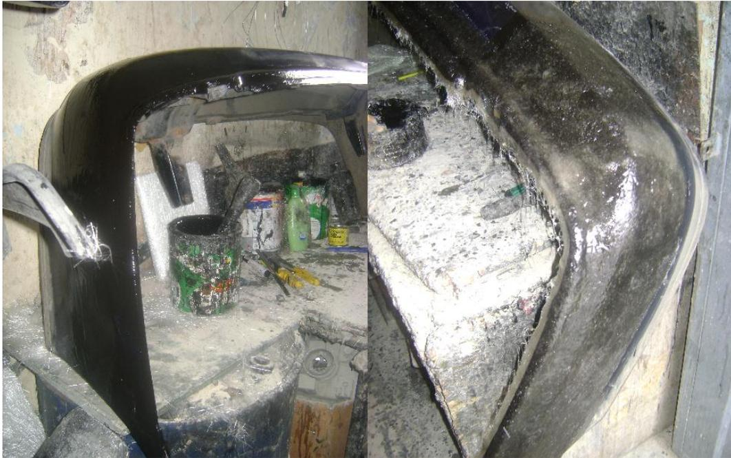
**Figura No. 97: Tratamiento de Matriz en Fibra de Vidrio para la construcción de Faldón Trasero.**
