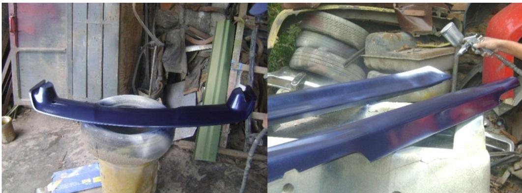
**Figura No. 114: Alerón y estribos laterales con la primera mano de pintura.**
