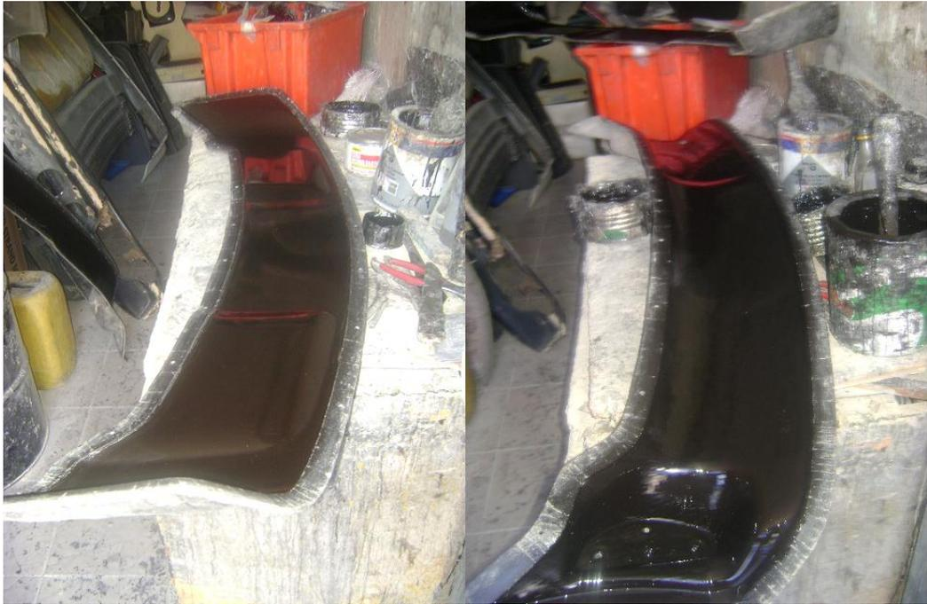
**Figura No. 93: Tratamiento de Matriz de Fibra de Vidrio para la construcción del Alerón.**
