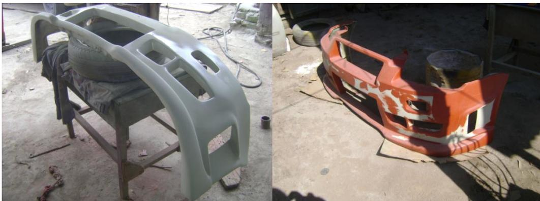
**Figura No. 108: Fondeado y masillado primario de Faldón Delantero.**
