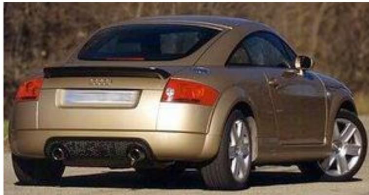
**Figura No. 44: Audi TT con alerón posterior.**
