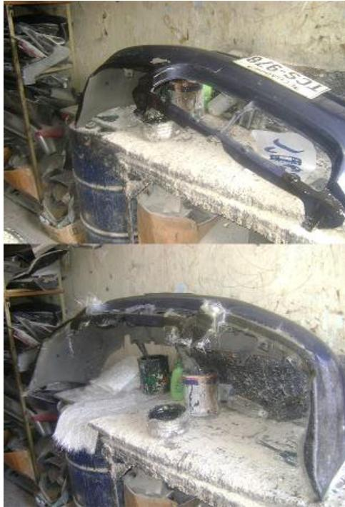
**Figura No. 95: Tratamiento de Matriz de Fibra de Vidrio para la construcción del Faldón Delantero.**
