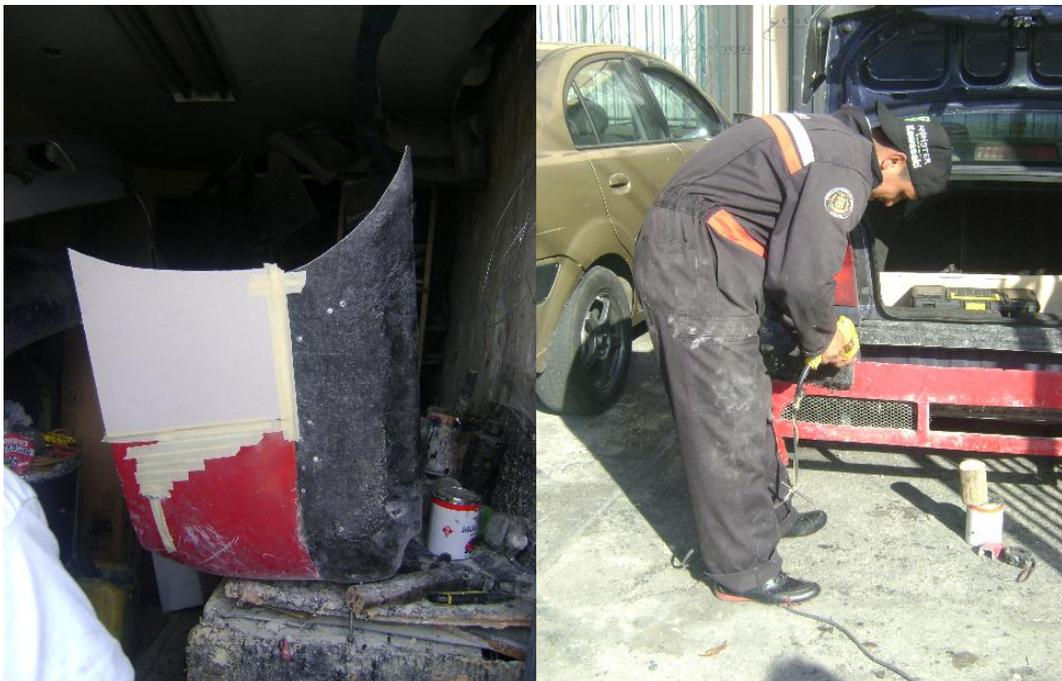
**Figura No. 98: Tratamiento de Matriz en Fibra de Vidrio para la construcción del Faldón Trasero.**
