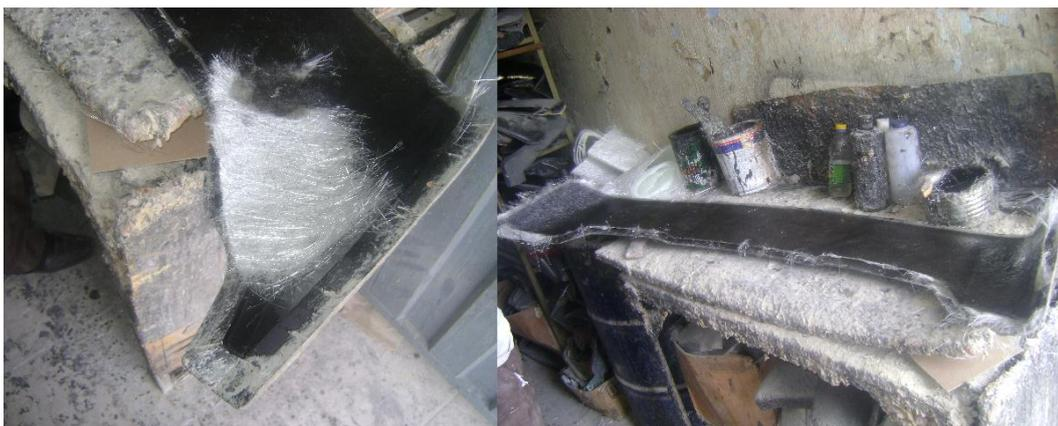
**Figura No. 99: Colocación de Fibra de Vidrio con mezcla de resina en la matriz tratada y seca por cuatro horas para la fabricación del Alerón.**
