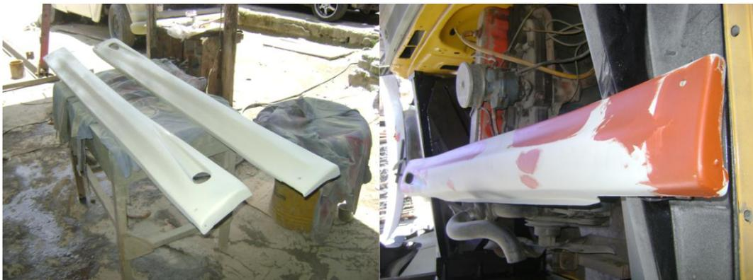
**Figura No. 107: Fondeado y masillado primario de los Etribos Laterales.**
