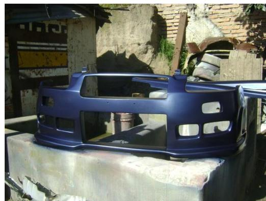
Figura 1d. Faldón Delantero construido en Fibra de Vidrio.
