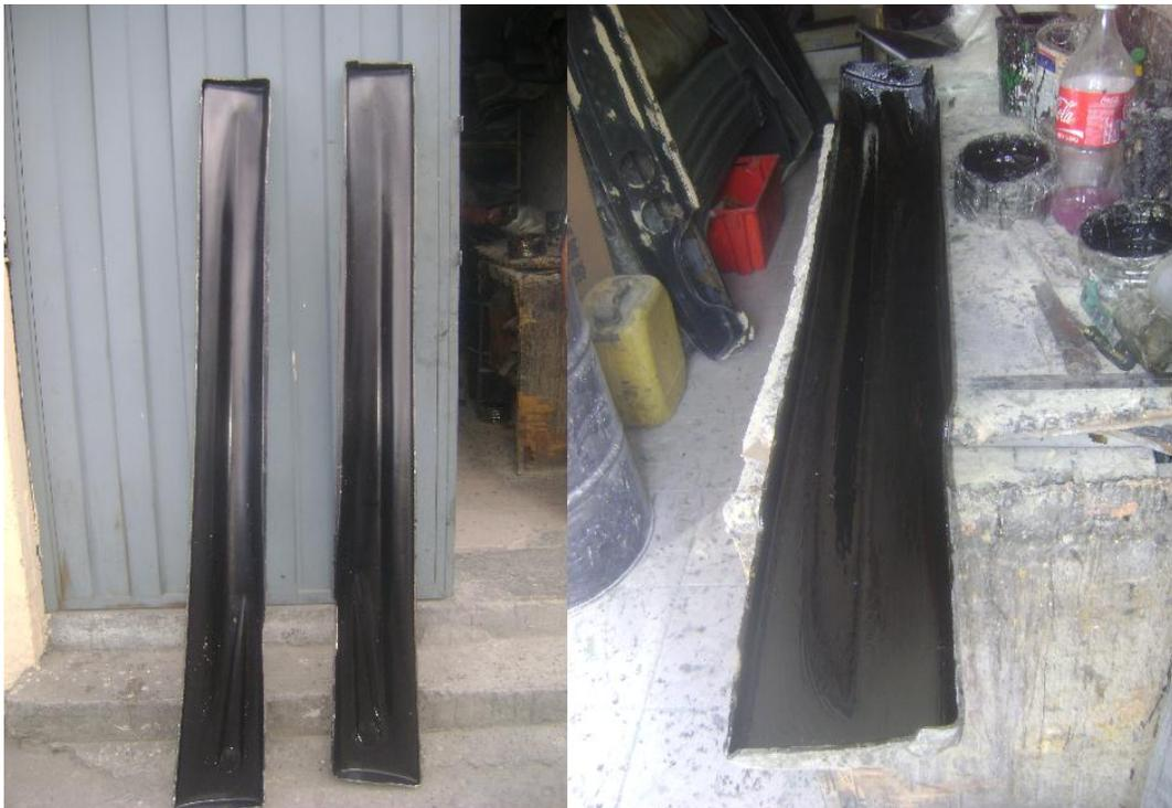
**Figura No. 94: Tratamiento de Matriz de Fibra de vidrio para la construcción de Etribos.**
