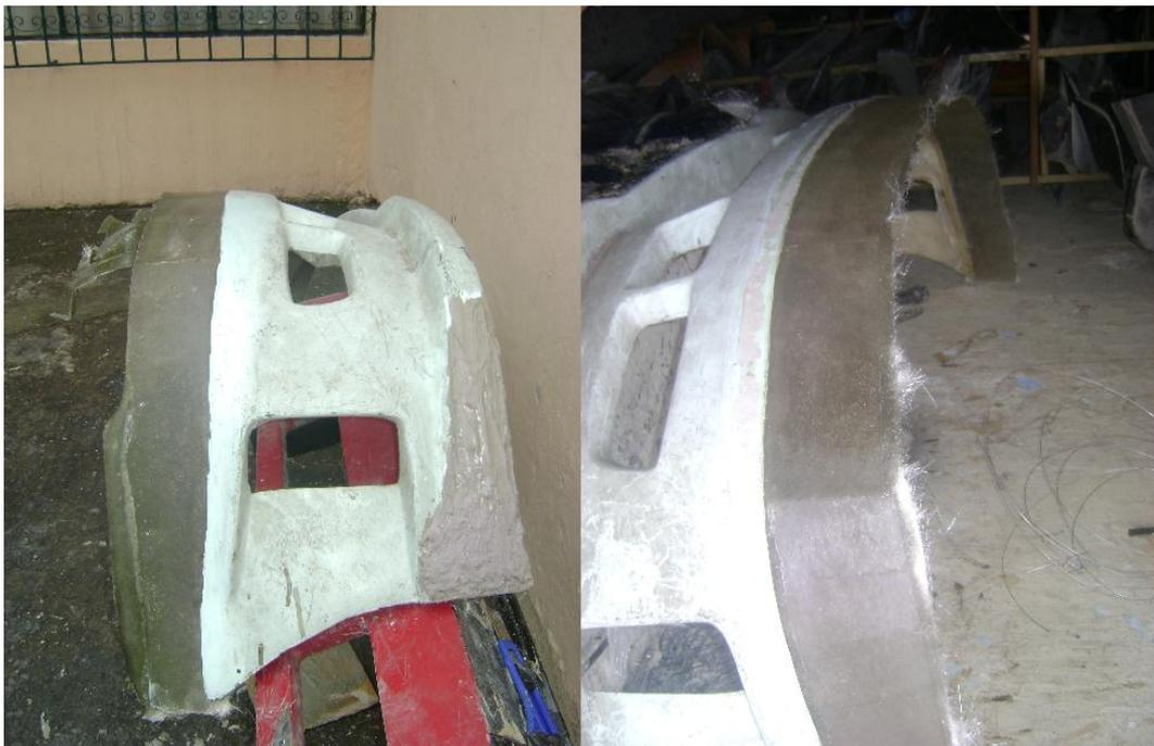
**Figura No. 101: Colocación de Fibra de Vidrio con mezcla de resina sobre la matriz tratada y seca por cuatro horas para la fabricación del faldón delantero.**
