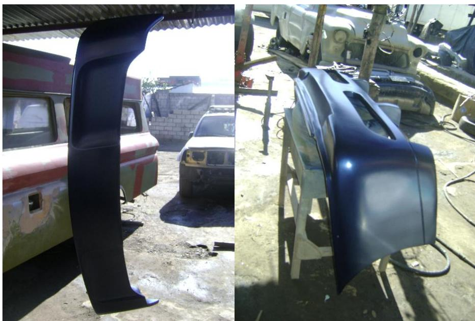
**Figura No. 121: Faldón Trasero y Alerón con la mano final de pintura.**
