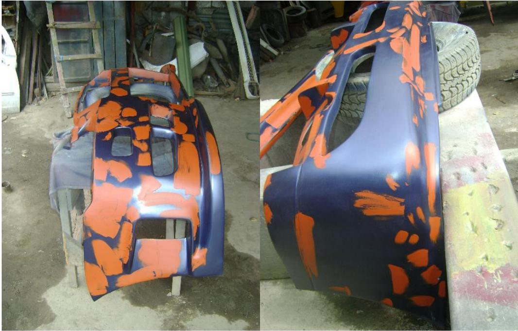
**Figura No. 116: Faldón Delantero y Trasero con su ultimo masillado.**
