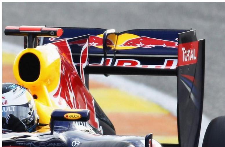
**Figura No. 23: Alerón de dos elementos.**
