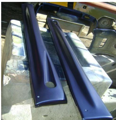
**Figura No. 120: Estribos con la mano final de pintura.**
