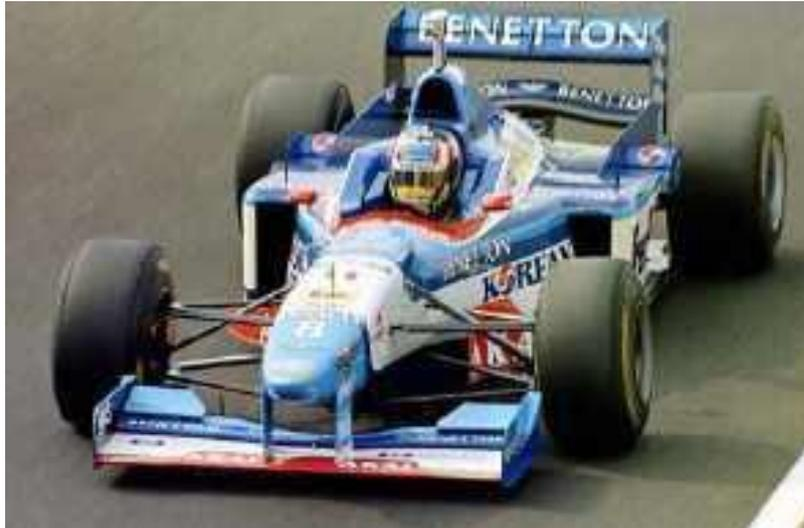
**Figura No. 26: Alerón de doble plano en el Benetton B197.**
