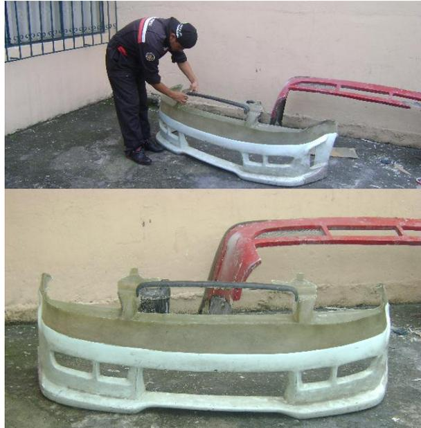
**Figura No. 102: Colocación de Fibra de Vidrio con mezcla de resina en la matriz tratada y seca por cuatro horas para la fabricación del Faldón Delantero.**
