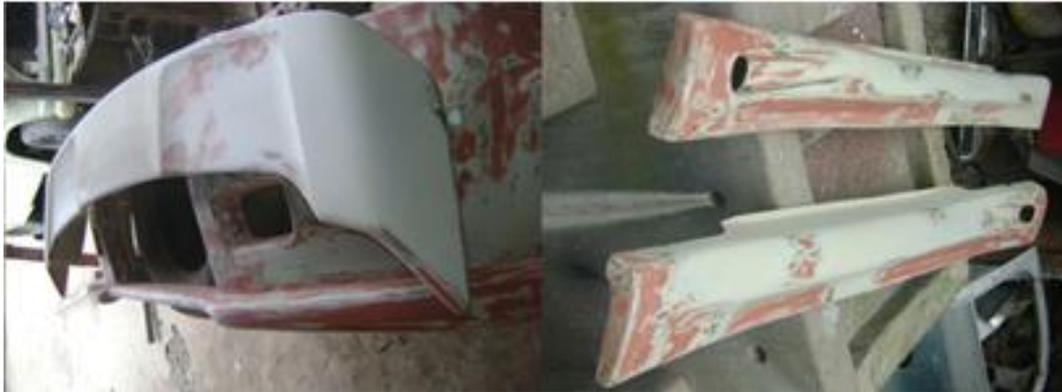
**Figura No. 110: Alerón y estribos lijados con lija N.80**
