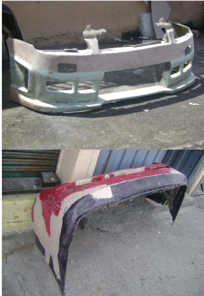
**Figura No. 104: Accesorios aerodinámicos con masilla plástica en las imperfecciones.**
