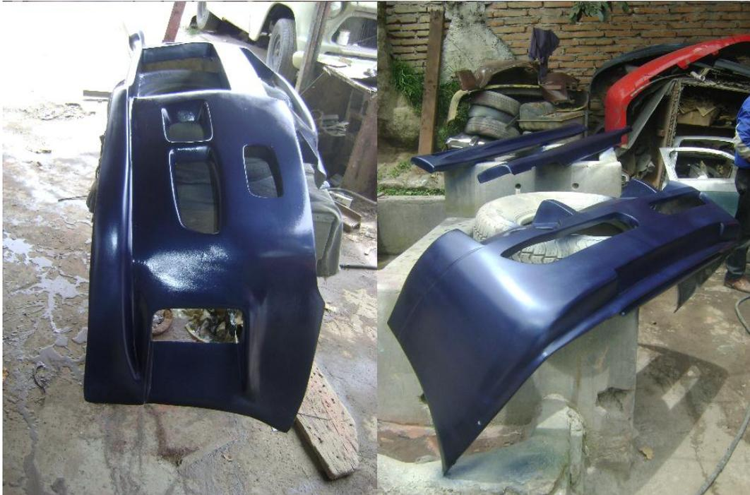
**Figura No. 115: Faldones delantero y trasero con la primera mano de pintura.**
