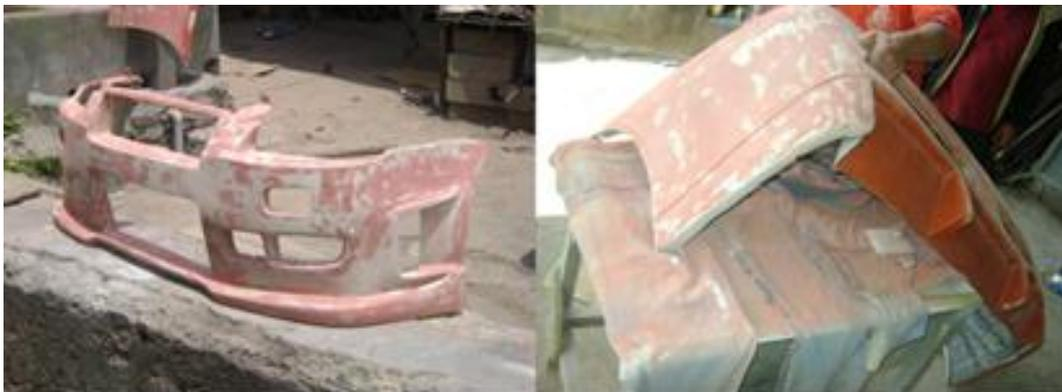
**Figura No. 111: Faldón delantero y trasero lijados con lija N. 80.**
