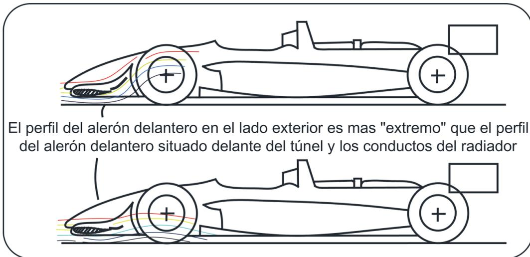
**Figura No. 37: Coche con túnel y alerón delantero asimétrico.**
