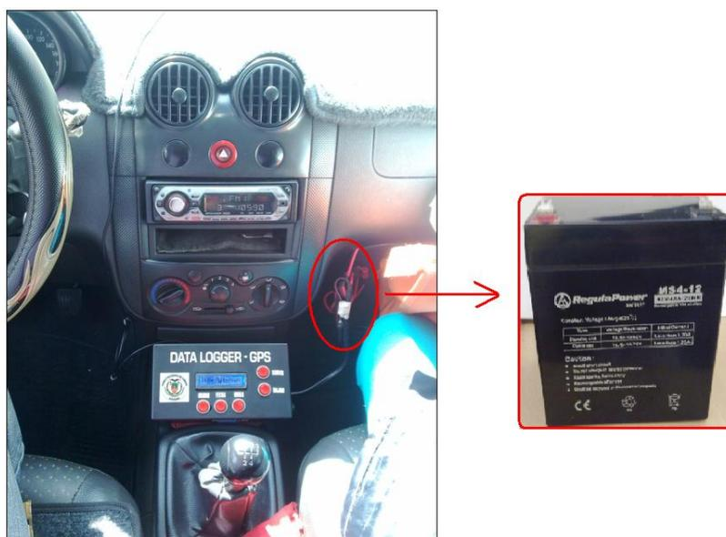
*Figura 2.20 Conexión del Módulo hacia la Batería Principal*
