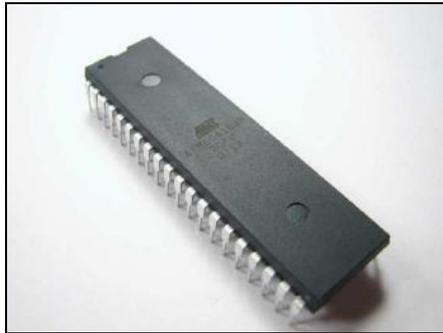
*Figura 1.12 Microcontrolador ATMEGA 164P*
