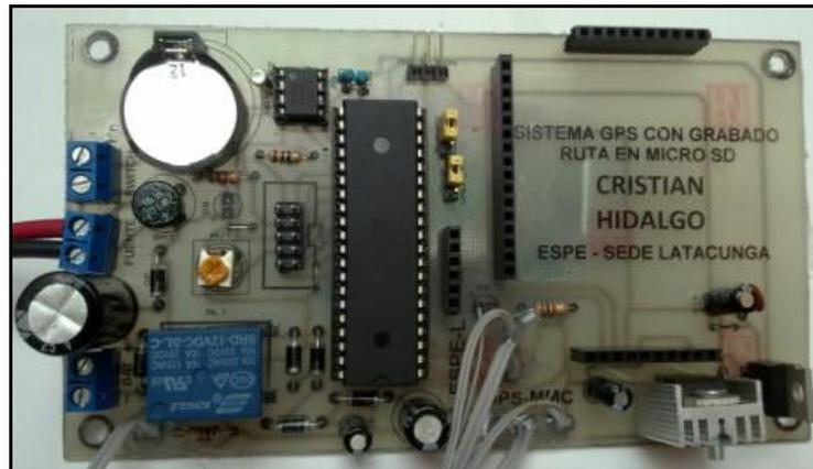
*Figura 2.15 Placa principal con componentes montados*
