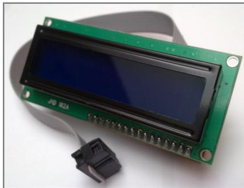
*Figura 1.22 Pantalla de Cristal Liquido – LCD 16x2*
