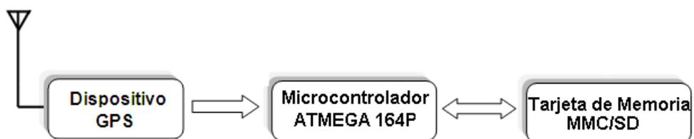
*Figura 2.1 Diagrama de Bloques General del Hardware*
