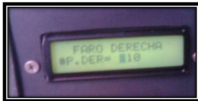
Fig. 4.20 Calibración del número pasos hacia la derecha del faro derecho.
