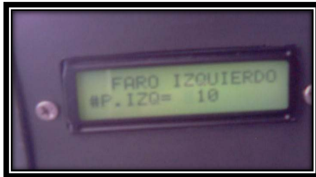
Fig. 4.13 Calibración del número de pasos hacia la izquierda del faro izquierdo.
