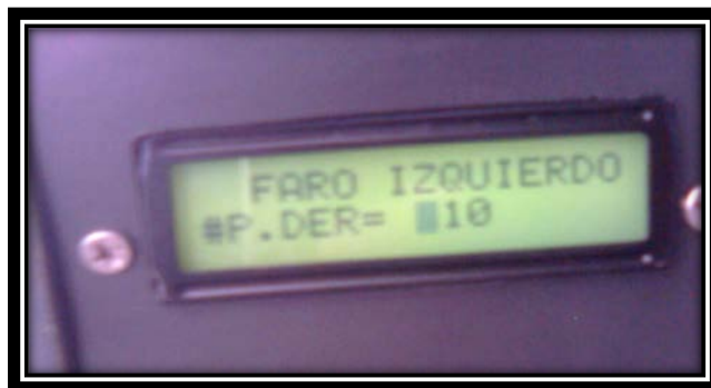
Fig. 4.14 Calibración del número de pasos hacia la derecha del faro izquierdo.
