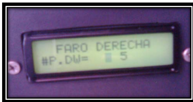
Fig. 4.23 Calibración del número pasos descendentes del faro derecho.
