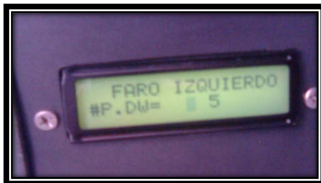
Fig. 4.17 Calibración del número de pasos descendentes del faro izquierdo.
