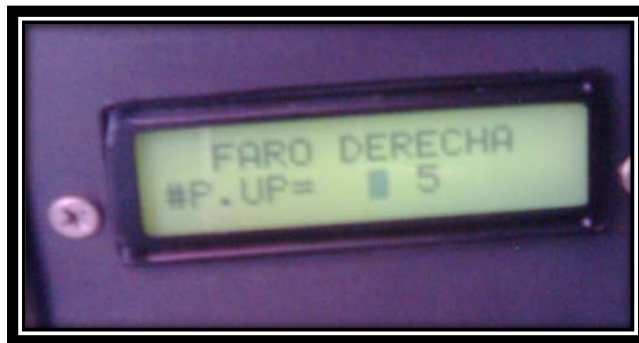
Fig. 4.22 Calibración del número pasos ascendentes del faro derecho.
