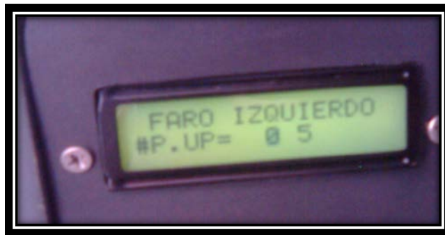
Fig. 4.16 Calibración del número de pasos ascendentes del faro izquierdo.
