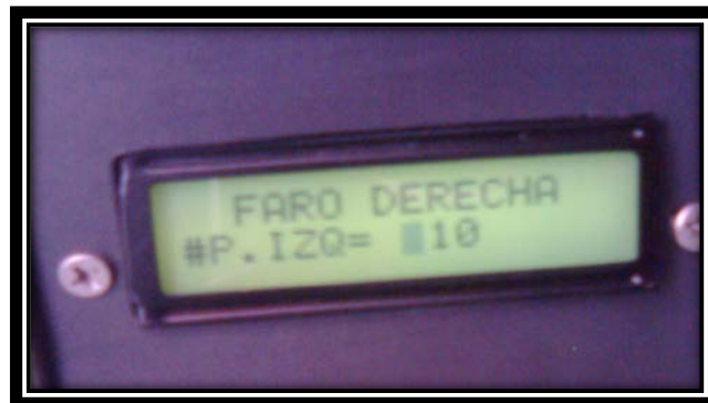
Fig. 4.19 Calibración del número pasos hacia la izquierda del faro derecho.
