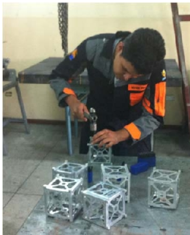
Figura 3.9. Proceso de numeración de los prototipos con números y letras de golpe
