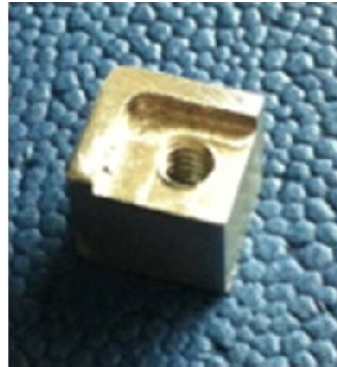
Figura 3.1: Contacto del prototipo CubeSat modificado con perforación M3 con rosca fina.
