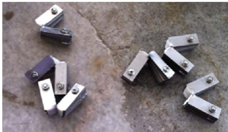
Figura 6.8. Probetas luego de los ensayos Charpy.
