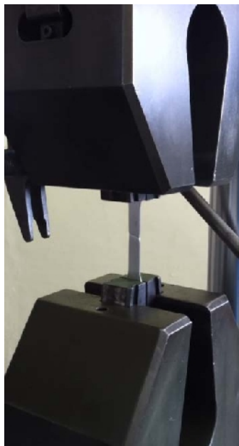
Figura 4.3. Ensayo de tracción en probetas de aluminio.
