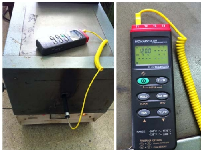
Figura 6.2. Horno de mufla a 120°C
