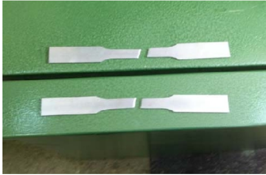
Figura 4.4. Probetas luego del ensayo tracción.
