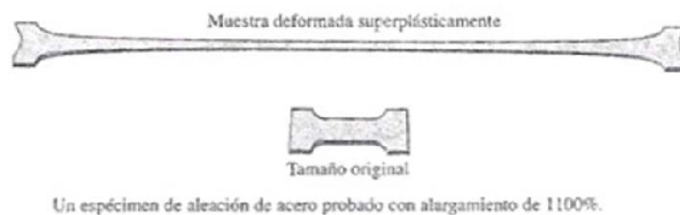
Figura 2.11. Representación de falla de una probeta de acero aleado deformada superplásticamente con alargamiento de 1100%.
