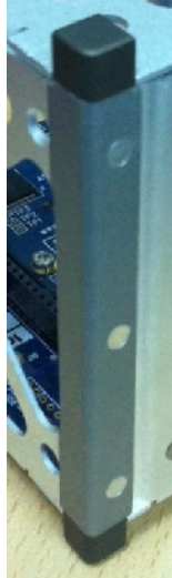
Figura 2.7: Arista que funciona como riel en un CubeSat desarrollado por Pumpkin INC.
