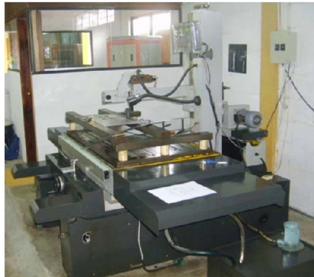
Figura 3.7: Máquina de corte por hilo de tungsteno mediante electroerosión, empresa “ALMETAL” Quito-Ecuador.
