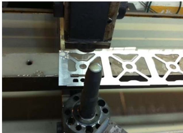
Figura 3.3: Corte de hilo por electroerosión empresa “AL-METAL” Quito-Ecuador.
