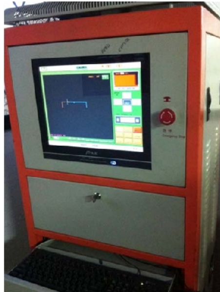
Figura 3.6: Sistema computarizado de control numérico para la máquina de corte.
