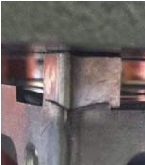
Figura 4.23. Uno de los vértices deformados del prototipo estructural del picosatélite CubeSat.
