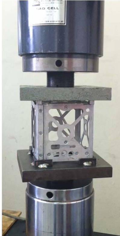
Figura 5.4. Prototipo “CubeSat” listo para ensayo de fatiga.
