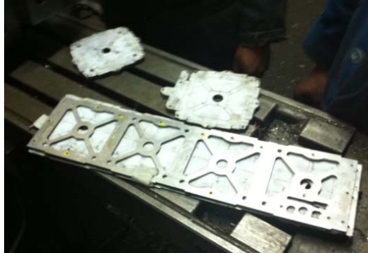
Figura 3.5: Perforaciones de sujeción y avellanados realizados en fresadora.
