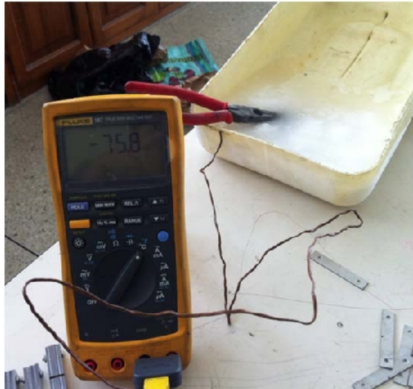
Figura 6.15. Disminución de temperatura de probetas con hielo seco y alcohol.
