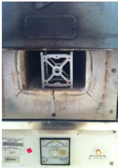
Figura 6.1. Prototipo CubeSat dentro del horno
