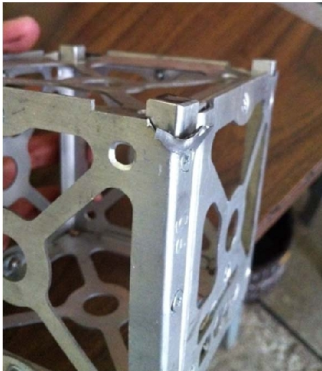
Figura 7.2. Fallas del prototipo P2.
