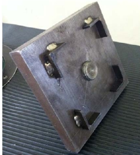
Figura 5.1. Accesorio fabricado para ensayo de fatiga
