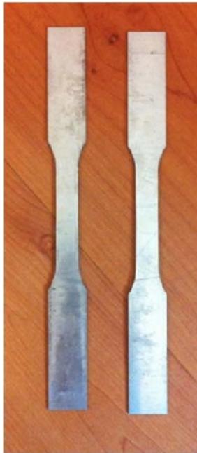
Figura 4.2. Probetas de aluminio 1050 listas para los ensayos de tracción.
