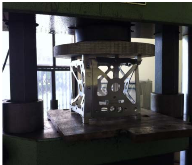
Figura 4.9. Prototipo estructural tipo CubeSat sometido a ensayo de compresión hasta la falla.
