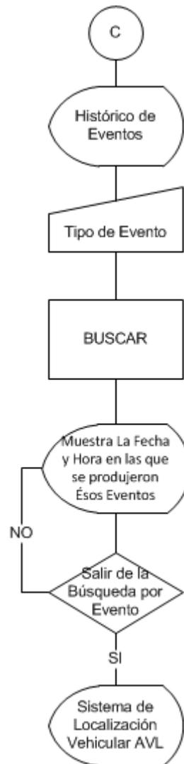
Figura 3.6: Diagrama de Flujo para Búsqueda en Base de Datos por Evento.
