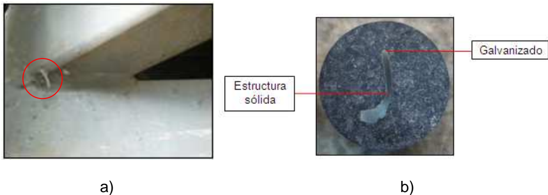
Figura 2. Proceso de soldadura; a) electrodo de alambre, b) superficie pulida
