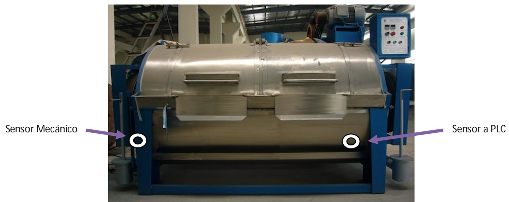
Figura. 1.6. Posicionamiento de sensores en la estructura de lavadora industrial
