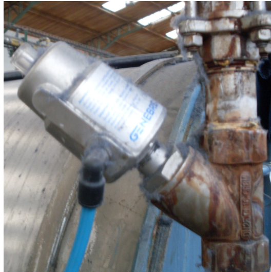
Figura. 1.22. Cilindro simple, actuador de vapor
