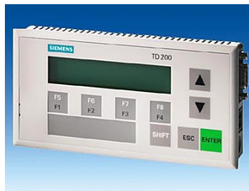
Figura. 1.13. Interfaz humano – máquina de operación local
