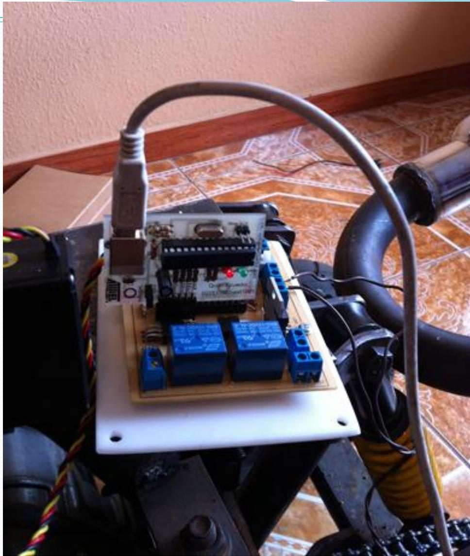
Tarjeta programadora de AVR's conectada a la placa principal
