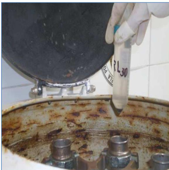
Figura 3.21: Ingresando la muestra salida del digester aforada a 50ml en el centrifugador
