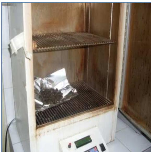
Figura 3.18: Secado de la Muestra de Sedimentos
