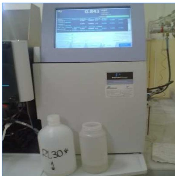
Figura 3.23: Equipo de Espectroscopia por absorción atómica
