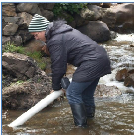
Figura 3.15: Toma de Muestra de Sedimentos con tubo PVC
