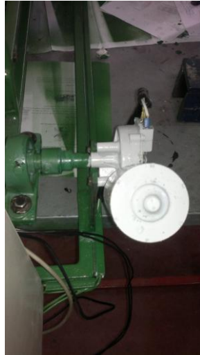
Figura 3.4: Motor de la banda principal conectado al rodillo
