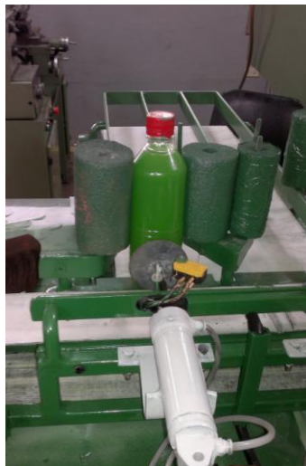
Figura 3.10: Transporte de botellas usando el segundo pistón
