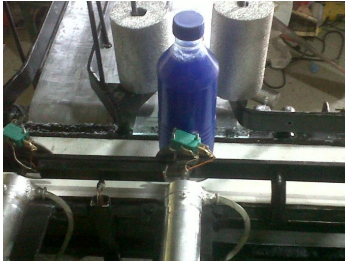
Figura 3.7: Botella activando el primer interruptor
