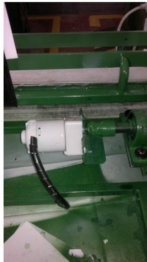
Figura 3.5: Motor de la banda secundaria conectado al rodillo
