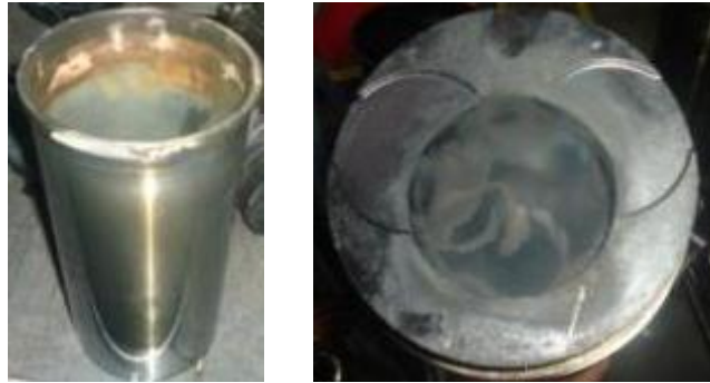
Gráfico No 18: Camisa –pistón rayados y carbonizados
