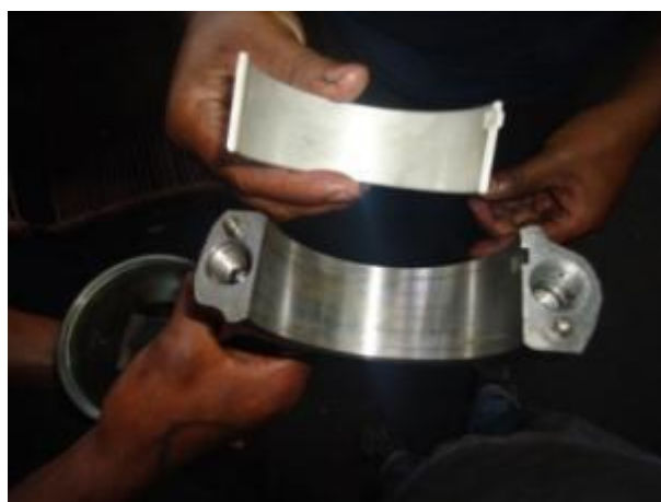
Gráfico No 61: Reconstrucción de la biela número 4
