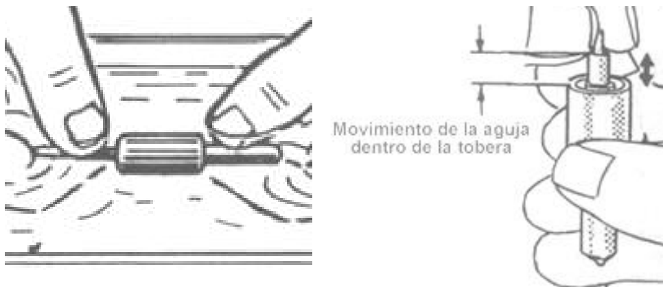
Gráfico No 119: Movimiento de la aguja del inyector
