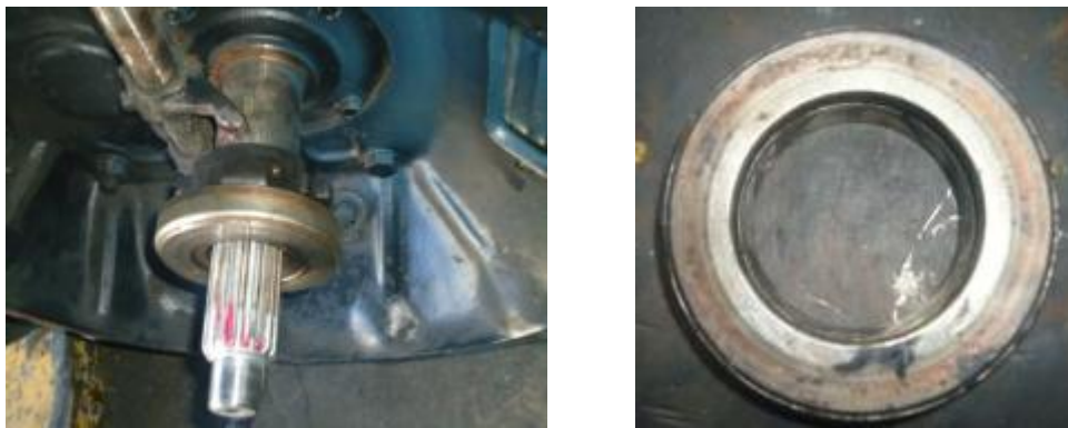
Gráfico No 24: Rodamiento del embrague mal estado
