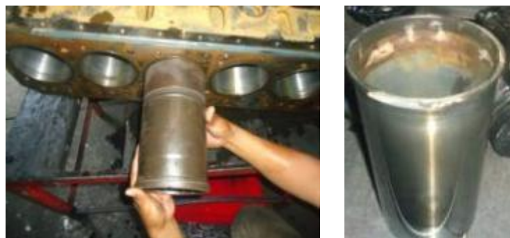
Gráfico No 42: Instalación camisas motor
