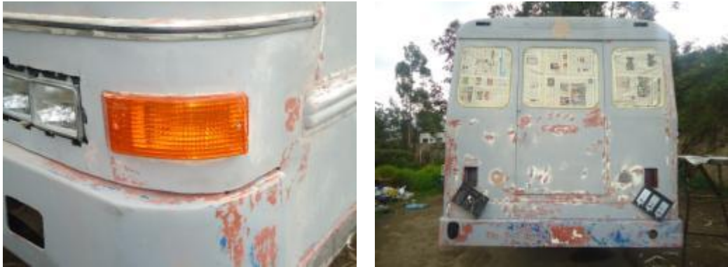
Gráfico No 160: Eliminación del exceso de pintura
