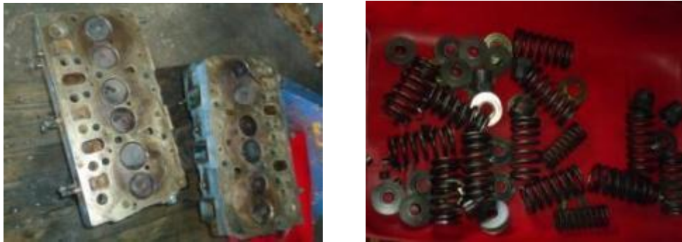
Gráfico No 49: Asentamiento de válvulas y armado de cabezote
