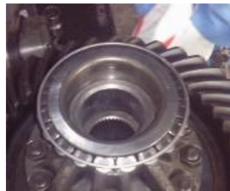
Gráfico No 31: Rodamiento de cono desgastado
