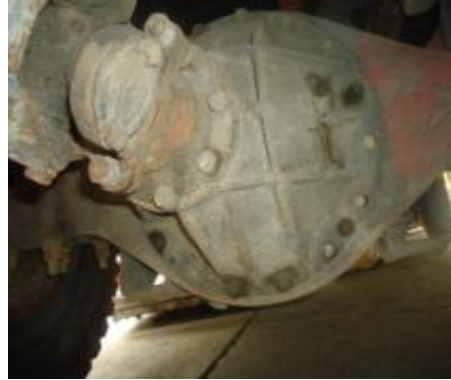
Gráfico No 29: Fuga de aceite en la transmisión
