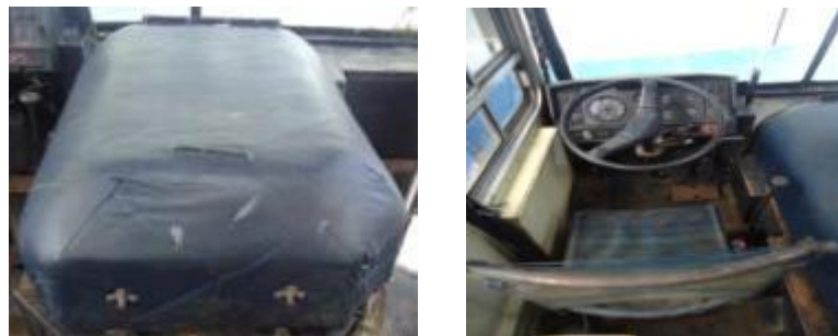
Gráfico No 9: Tapa del motor y asiento del conductor dañado
