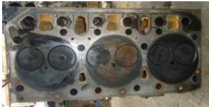
Gráfico No 19: Cabezotes oxidados y carbonizados
