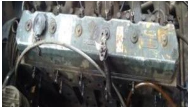
Gráfico No 14: Tapa de balancines con fugas de aceite
