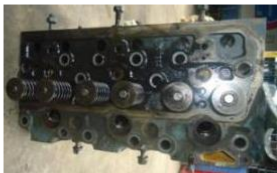
Gráfico No 20: Guías de Válvulas Averiadadas
