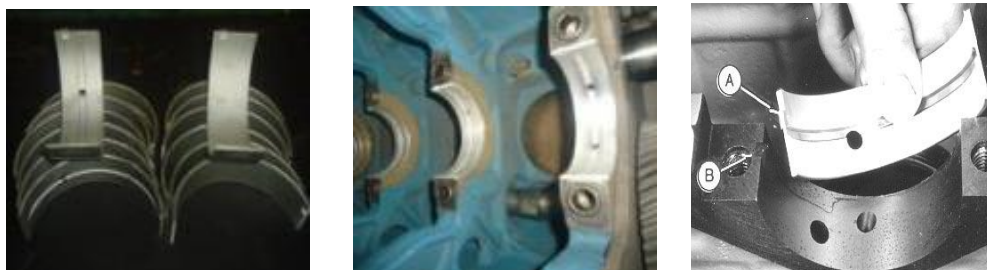
Gráfico No 44: Asentamiento de los cojinetes de bancada +10
