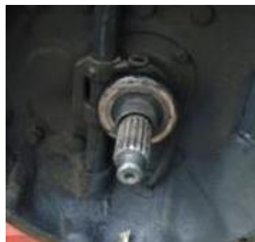
Gráfico No 15: Rodamiento del embrague averiado y fugas de aceite
