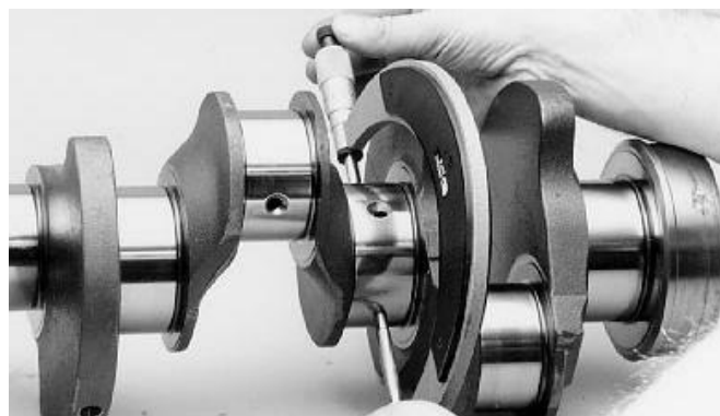
Gráfico No 87: Conicidad y ovalamiento del cigüeñal
