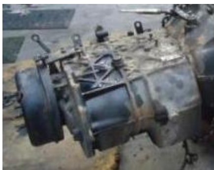
Gráfico No 22: Fugas de aceite en la caja de cambios
