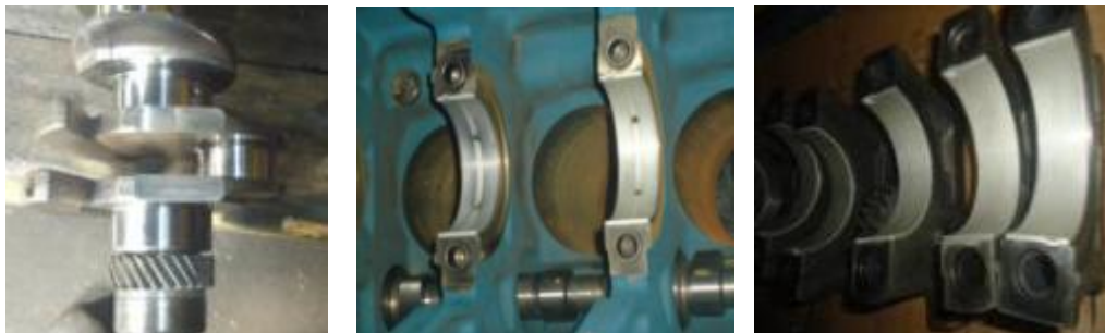
Gráfico No 57: Codo de bancada rectificado con su Cojinete +10
