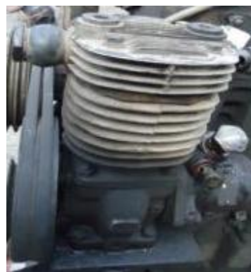
Gráfico No 11: Radiador oxidado y compresor con fugas de aceite
