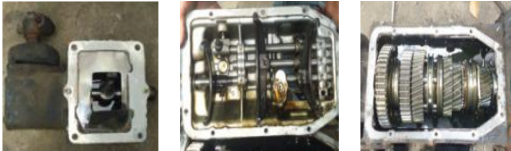
Gráfico No 26: Selector doblado y caja de cambios con fugas
