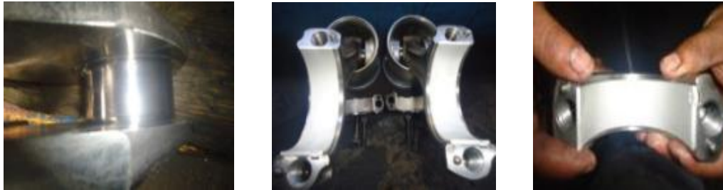
Gráfico No 56: Codo de biela rectificado +20 con su cojinete +20
