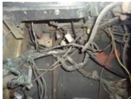
Gráfico No 36: Arnés destruido y sin panel de instrumentos
