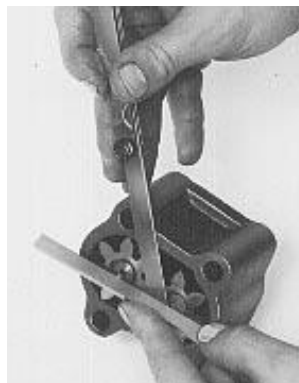
Gráfico No 85: Juego axial de engranaje de la bomba de aceite
