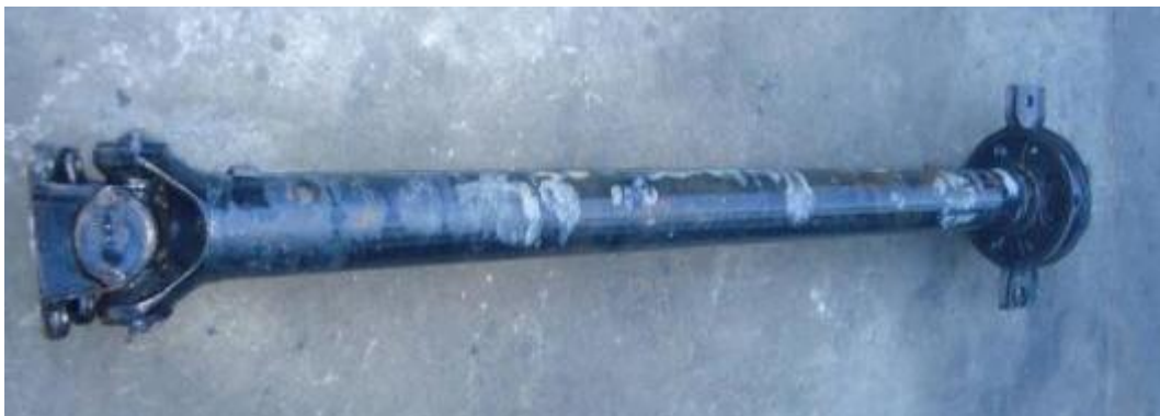
Gráfico No 28: Crucetas del árbol de transmisión deterioradas
