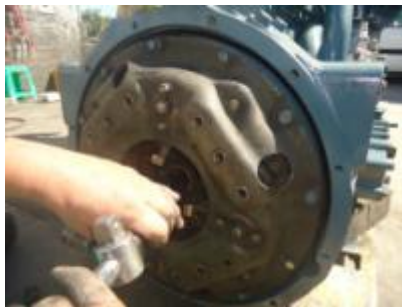
Gráfico No 125: Desmontaje del conjunto del embrague
