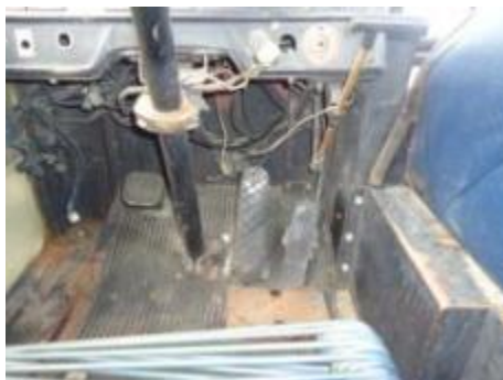
Gráfico No 36: Arnés destruido y sin panel de instrumentos
