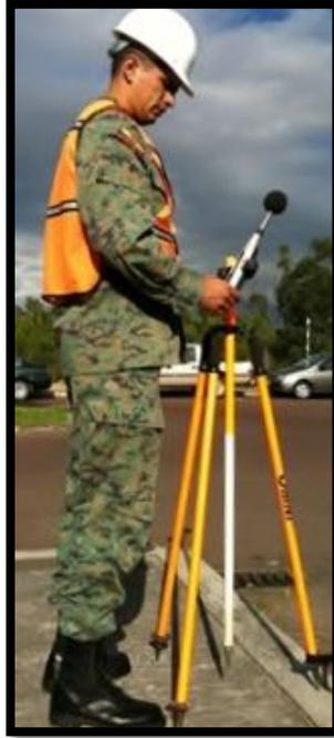
**Foto 3.6: Instalación trípode - sonómetro.**
