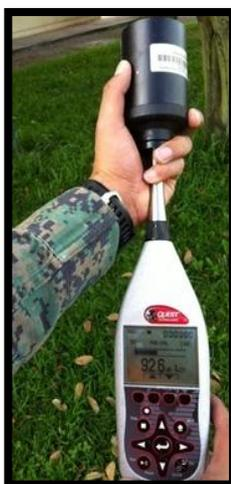
**Foto 3.5: Calibración de sonómetro en campo.
