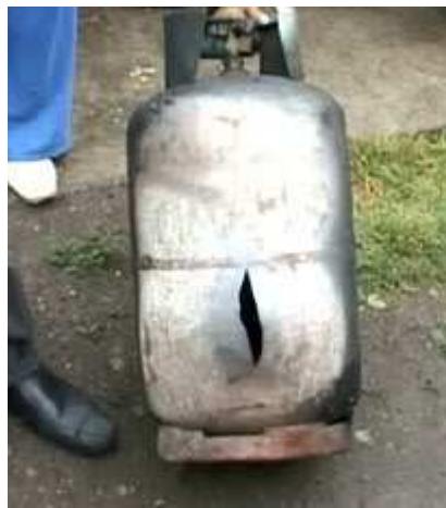
Figura 4.2 Ejemplo de tanque de GLP explotado.
