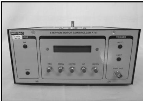
**Figura 1.6 Unidad de Control de Motor Paso a Paso**
