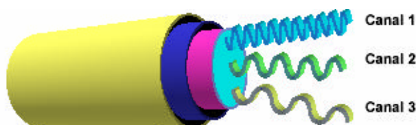
Figura. 5.11. Como Viaja WDM en una Fibra Óptica
