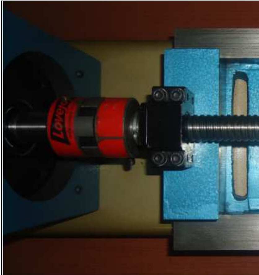
Figura 4.6. Acople flexible para el eje del servo-motor y el eje del tornillo de potencia. 125
