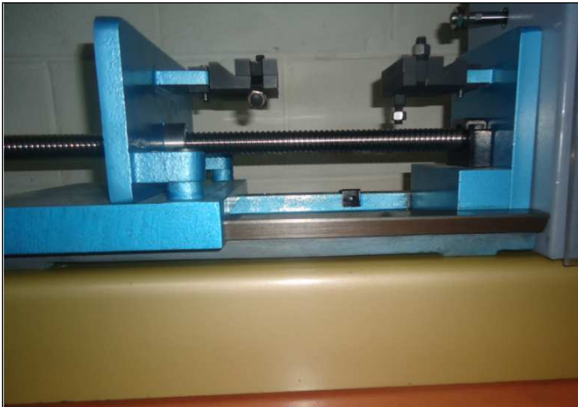
Figura 4.10. Ensamblaje del módulo de sujeción con el módulo de transmisión de potencia. 129
