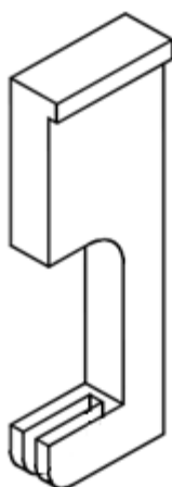
Figura 2.15. Herramienta auxiliar para la determinación de la resistencia a la fijación de la caja o retenedor fijo. 18
