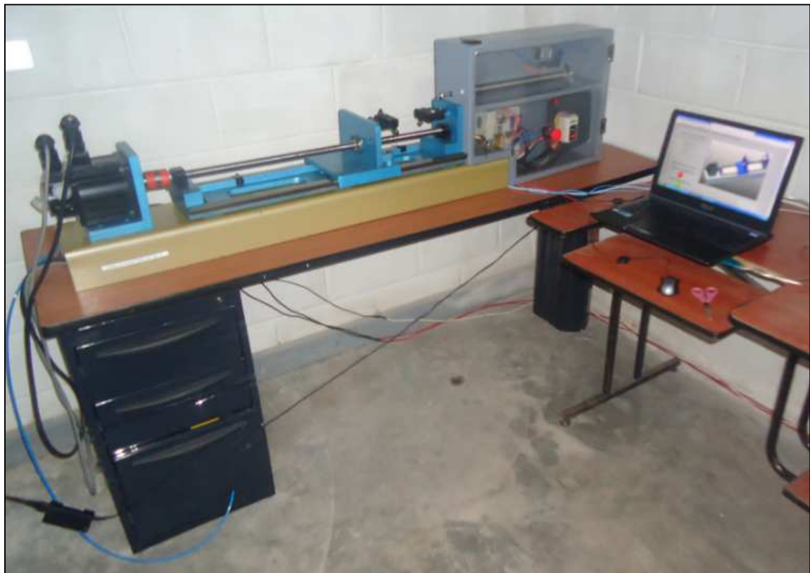
Figura 4.1. Ensamblaje de sistema modular y reconfigurable para el control de calidad de zippers. 120
