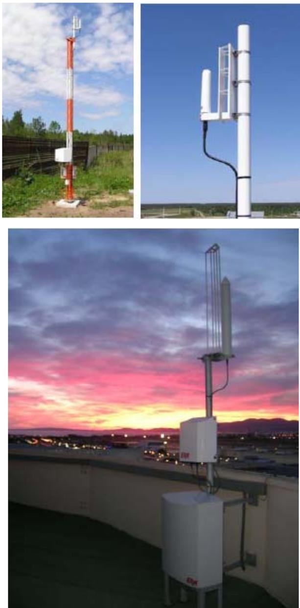
**Figura. 4. 18. Estación Modular Terrestre**
