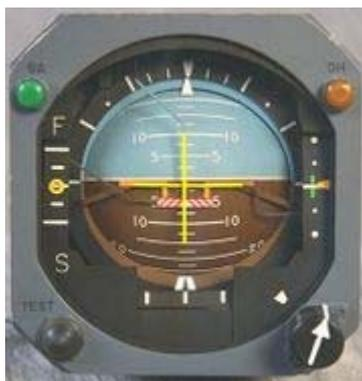
**Figura. 3. 21. Horizonte artificial.** En muchos aviones, aquí se muestran las dos agujas que marcan la senda correcta del ILS. De estar sintonizado un ILS durante la aproximación, las dos agujas en cruz indicarían que se está realizando correctamente la aeronavegación.
