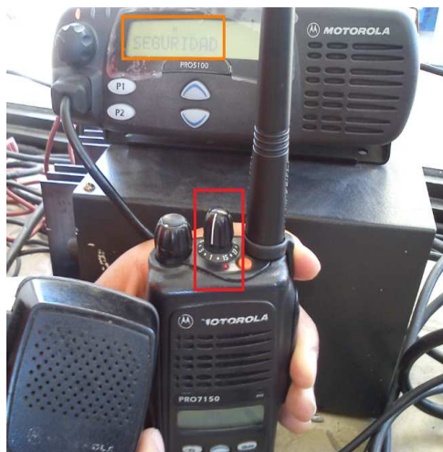
Figura. 3.59. Verificación del grupo SEGURIDAD y del canal 1 asignado
