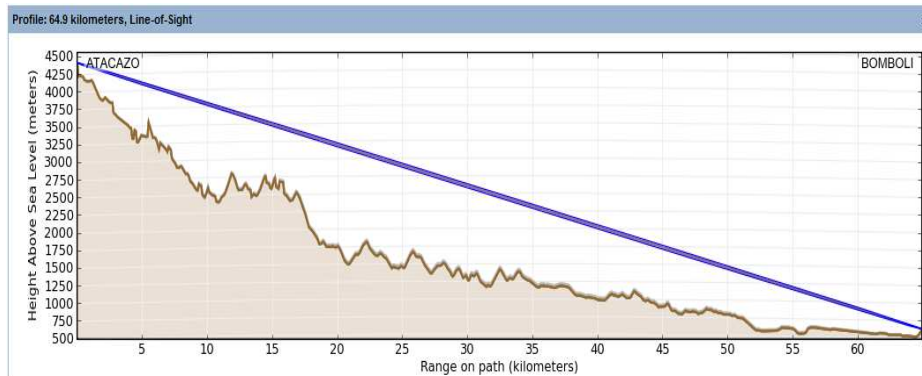
Figura 4. 28. Perfil topográfico enlace Atacazo – Bombolí.
