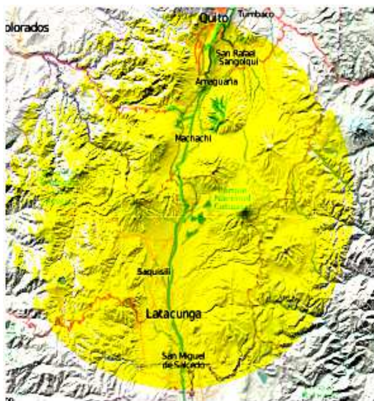
Figura 4. 6. Cobertura repetidora Sumi Loma
