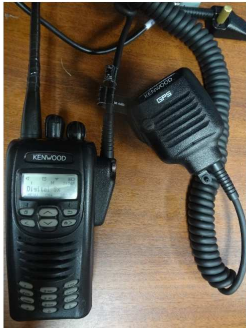
Figura 4. 47. Radio portátil digital y radio móvil digital para equipar en el vehículo
