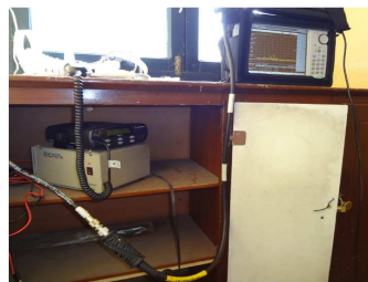
Figura. 2.15. Conexión del Analizador de Espectros en Héroes del Cenepa
