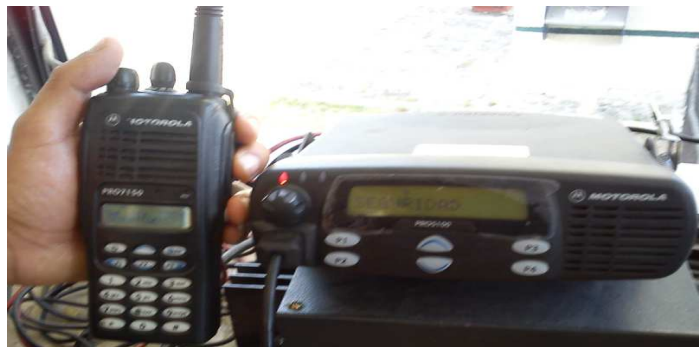
Figura. 3.60. Verificación de transmisión desde la radio portátil a radio base
