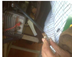
Figura. 3.26. Ajuste de conexión entre conector PL 259 y cable Belden.
