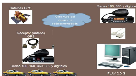
Figura. 1.12. Arquitectura de un sistema de radiolocalización digital para transportes
