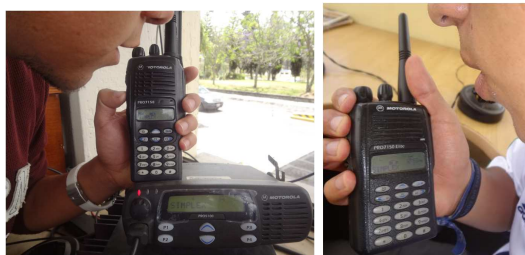
Figura. 3.58. Prueba de comunicación Grupo SIMPLEX
