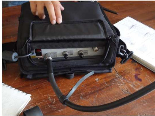
Figura. 2.10. Conexión del Cable de Prueba Anritsu al Analizador de Espectros
