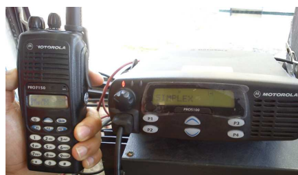
Figura. 3.63. Verificación de transmisión desde la radio portátil a radio base
