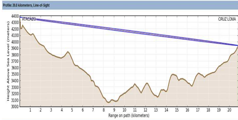
Figura 4.24. Perfil topográfico enlace Cruz Loma - Atacazo
