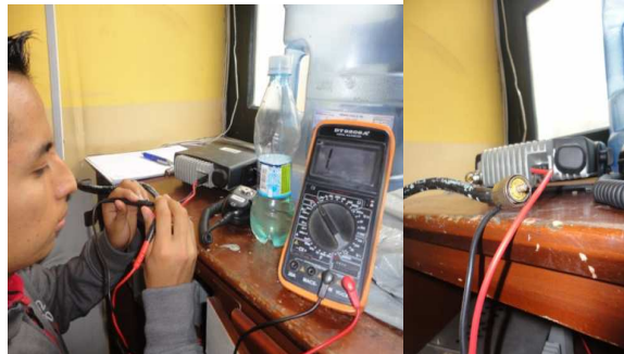
Figura. 3.14. Chequeo de Fuente y revisión de conectores.
