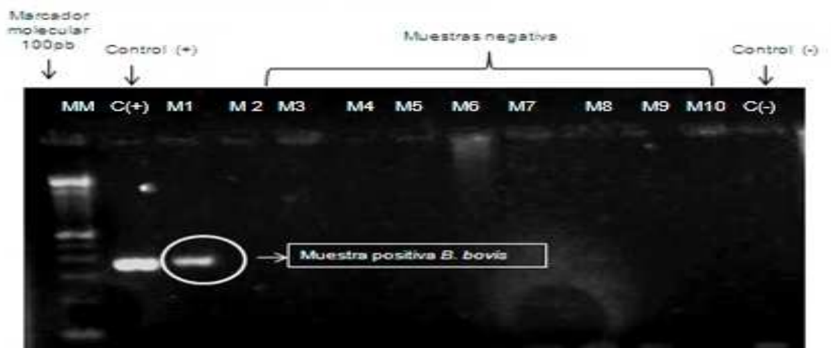
Figura 8: Electroforesis de productos de PCR Convencional de B. bovis , gel 2%, Muestras Camal Metropolitano de Quito, Hernández, 2012: C(+) = Control positivo B. bovis ; M1= Muestra camal positiva; M2=Muestra camal 2; M3=Muestra camal 3; M4: Muestra camal 4; M5=Muestra camal 5; M6=Muestra camal 6; M7=Muestra camal 7; M8=Muestra camal 8; M9=Muestra camal 9; M20=Muestra camal 10; C(-) = Control negativo.
