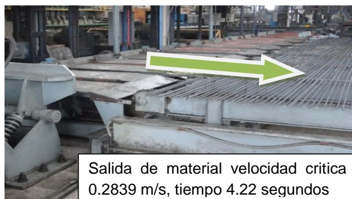
**Figura 4.2: Salida de material transferidor sur**
