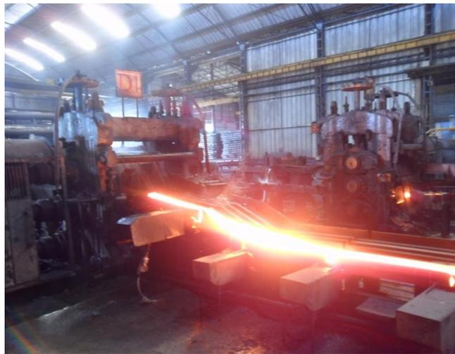
**Figura 1.5: Desbaste 1 del Tren de Laminación**
