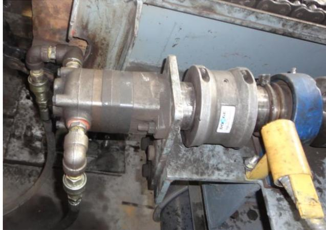
**Figura 3.11: Motor hidráulico, impulsor de la matriz**
