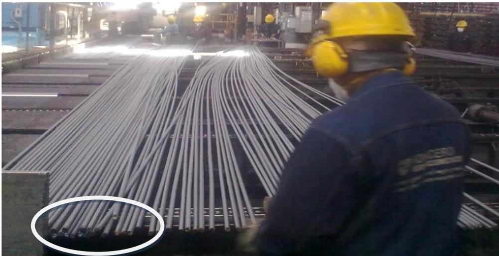
**Figura 2.4: Cama de varilla a la salida de la cizalla de corte en frio**
