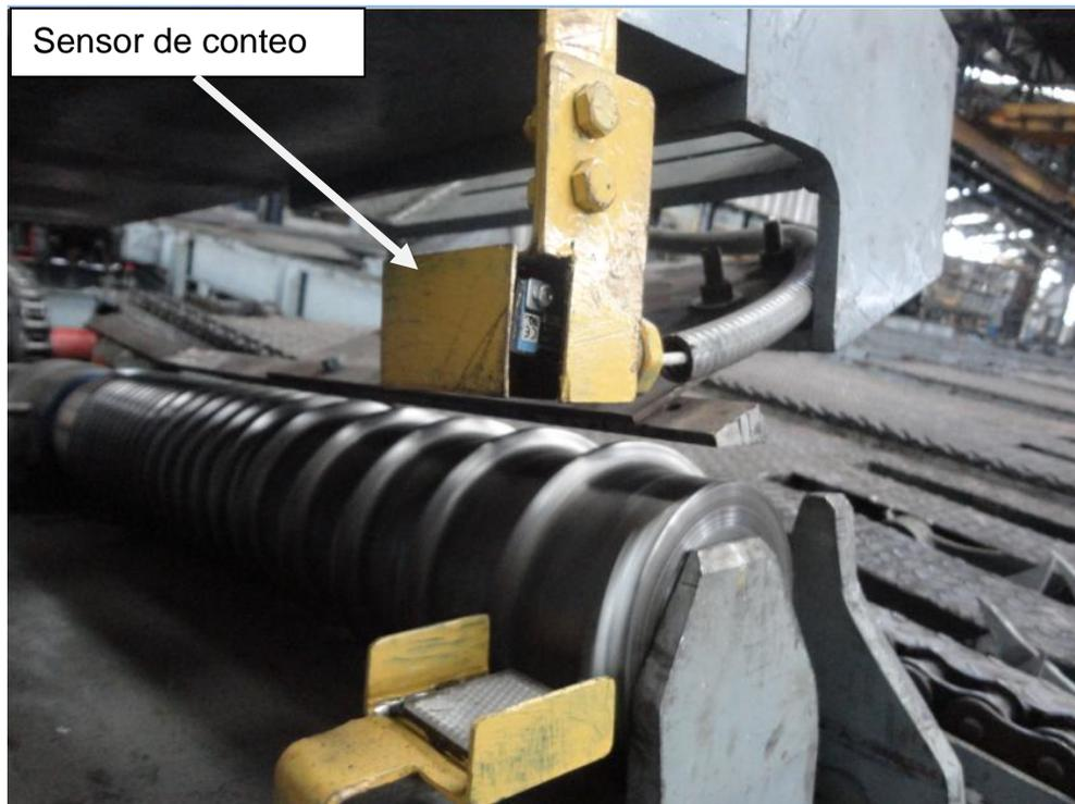
**Figura 3.19: Posicionamiento del sensor de conteo en función del modulo**
