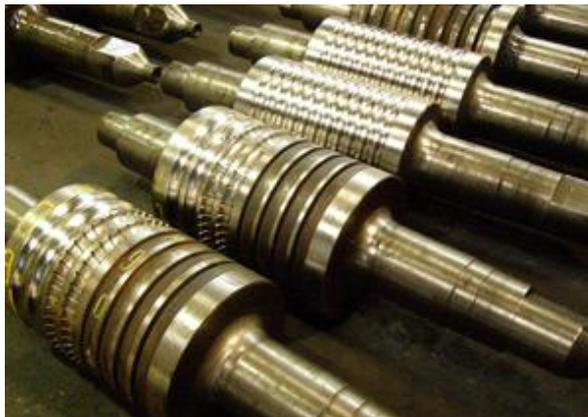
**Figura 1.3: Cilindros de laminación para secciones circulares**
