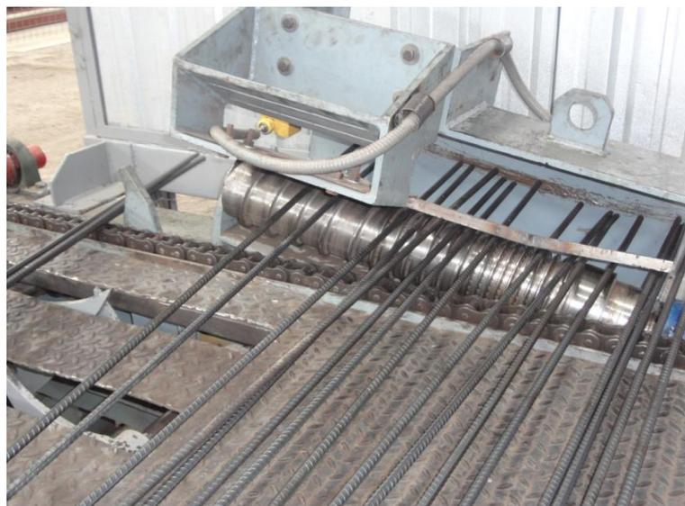
**Figura 3.21: Contador de varilla corrugada**
