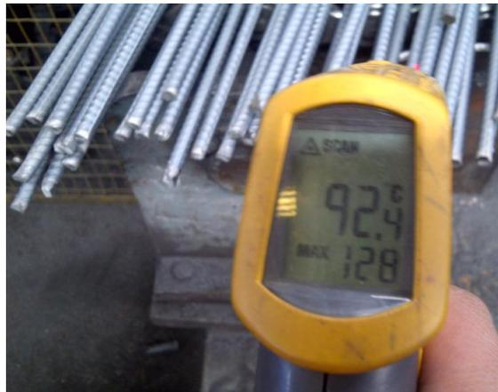
**Figura 2.96: Temperatura del material en el transferidor**
