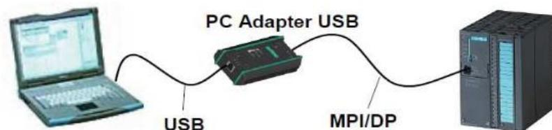
Figura 2.116: Configuración PC Adapter USB
