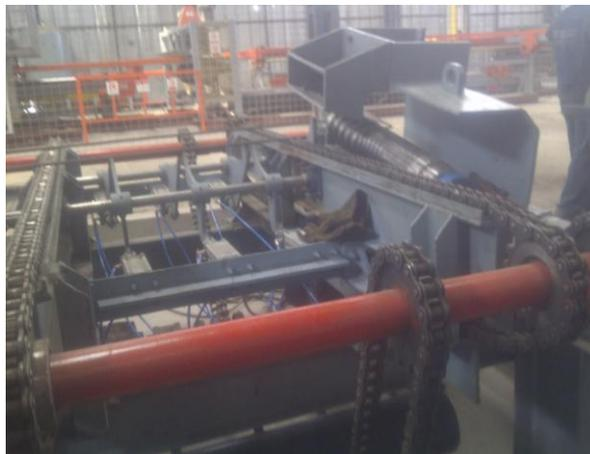
**Figura 3.7: Montaje y alineación del módulo de conteo**
