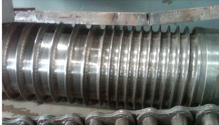
**Figura 1.7: Tornillo sin fin helicoidal**
