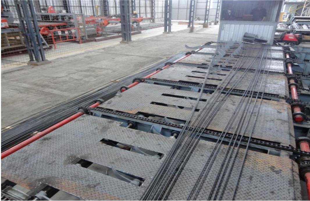
**Figura 3.22: Contador y separador de varilla corrugad**
