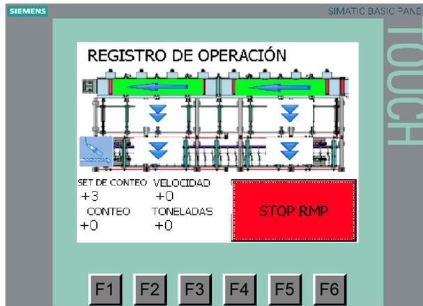
**Figura 2.134: Indicadores intermitentes del funcionamiento del transferidor y contador de varilla**
