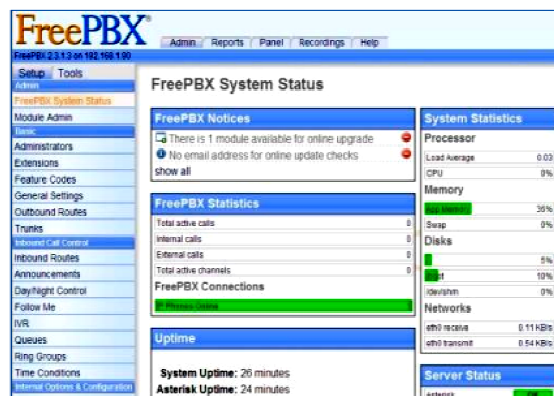
Figura. 3 Estado de sistema de asterisk en FreePBX
