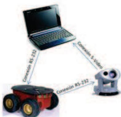
Figura 3-2.- Hardware que conforma el servidor del sistema ROMOTEVI
