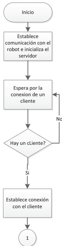
Figura 4-6.- Diagrama de flujo para el servidor ROMOTEVI (parte 1)
