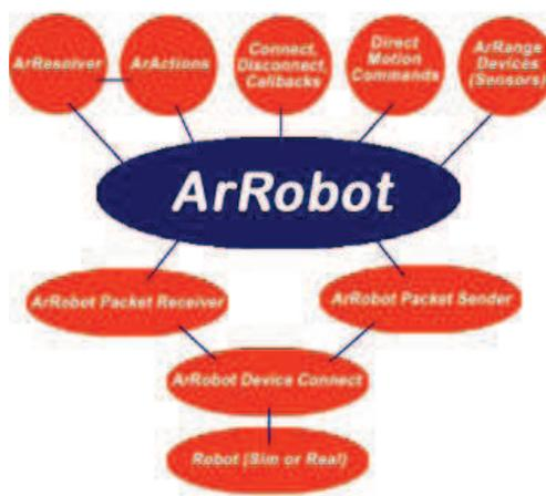
Figura 4-4.- Estructura de ArRobot de Aria
