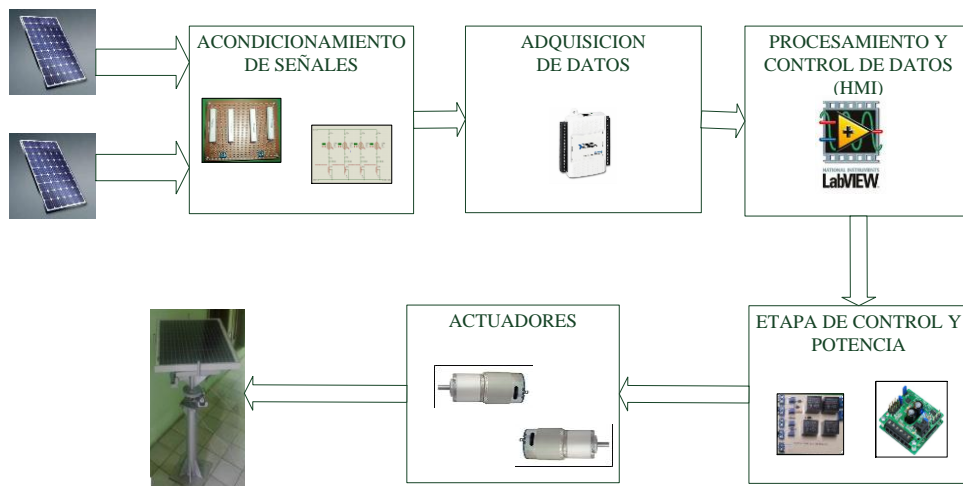
Figura 2. 1: Diagrama de bloques del sistema.
