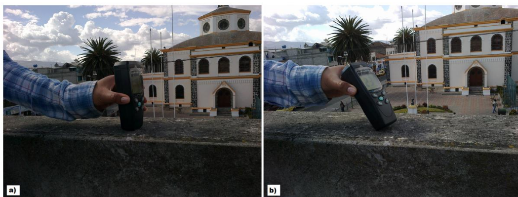
Figura 3. 1: a) Solarímetro perpendicular a una superficie horizontal b) Solarímetro perpendicular al Sol
