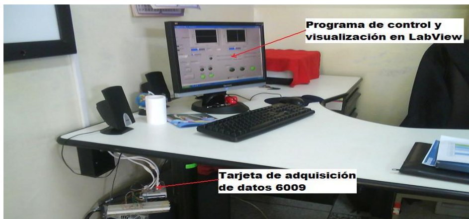
Figura 2. 29: Control del sistema con la tarjeta de adquisición de datos 6009.
