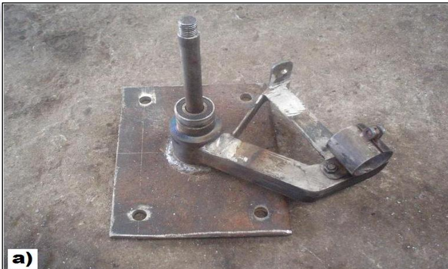
a) Base para motorreductor y eje principal, b) base de sujeción del motorreductor en altura solar.
