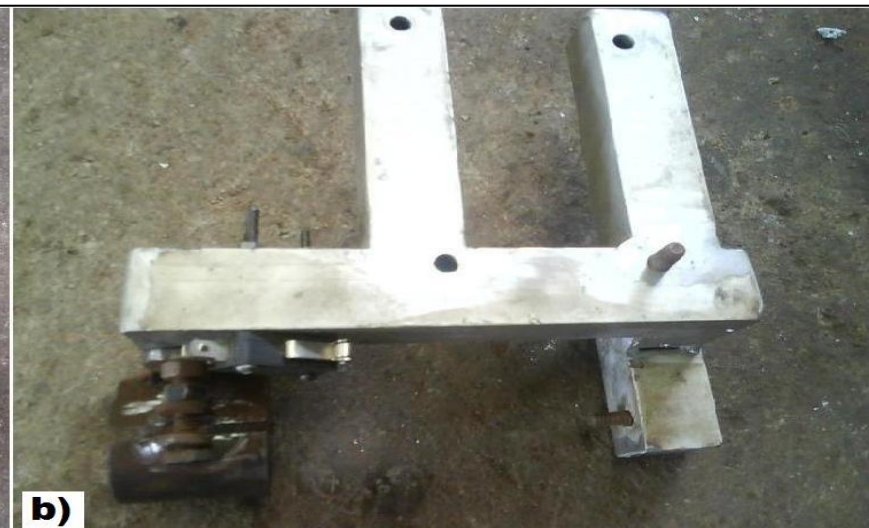
a) Base para motorreductor y eje principal, b) base de sujeción del motorreductor en altura solar.
