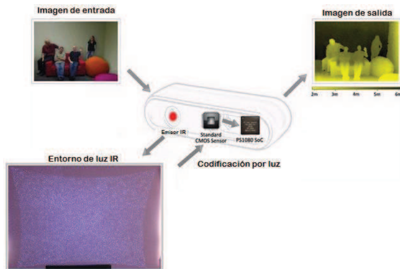
Figura 2.7 Esquema del método de captura del movimiento de Kinect
